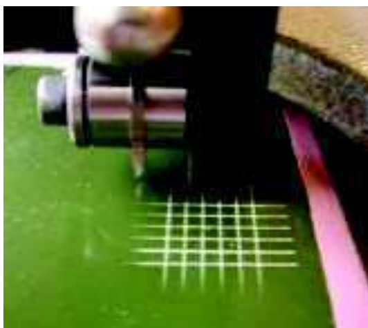
Obr. 10: Řez nožem při zkoušce mřížkovou metodou. (foto autor)
