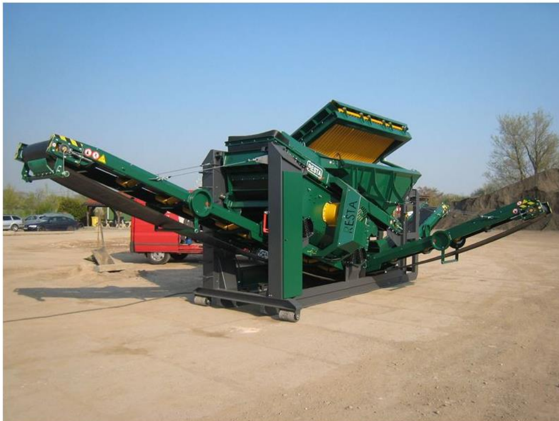
Obr. 9 Kontejnerová třídící jednotka TK6 - 3 1000 x 3000/2 [29]
