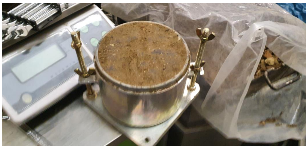
Obr. 59 Zhotovené těleso pro zkoušku IBI, recyklát s obsahem hlíny
