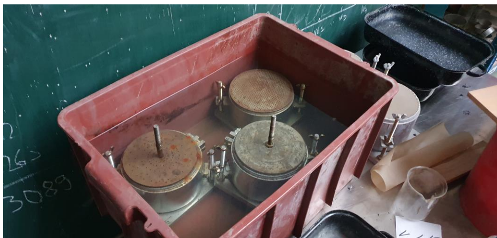
Obr. 60 Tělesa saturovaná pro zkoušku CBR
