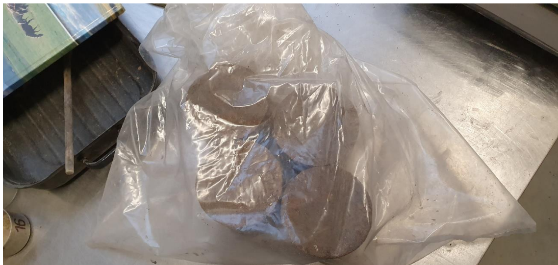
Obr. 52 Připravená tělesa recyklátu s obsahem hlíny pro zkoušku míru namrzavosti
