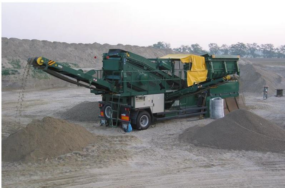
Obr. 8 Mobilní kolový recyklační drtič [30]
