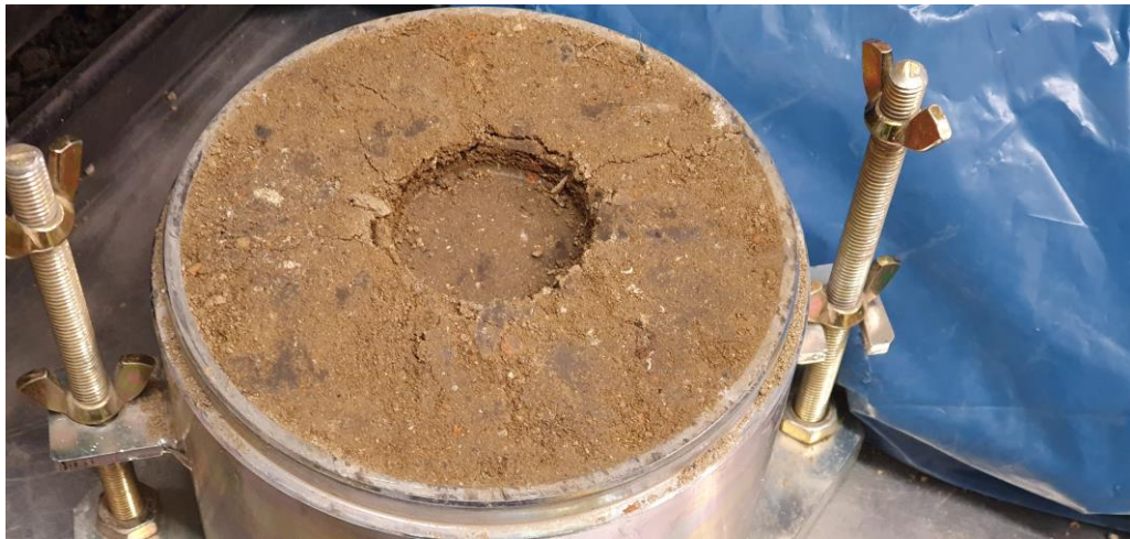
Obr. 62 Vzorek směšného recyklátu s hlinou po penetraci , zkouška IBI
