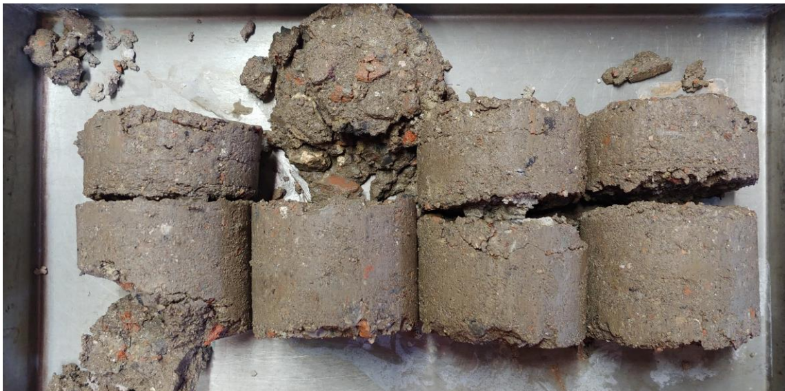
Obr. 55 Tělesa po zkoušce míry namrzavosti – recyklát s obsahem hlíny
