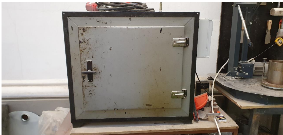
Obr. 38 Horkovzdušná sušící komora
