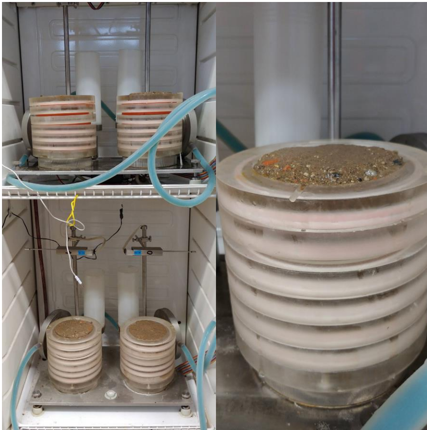
Obr. 53 Tělesa vložena do chladicího zařízení
