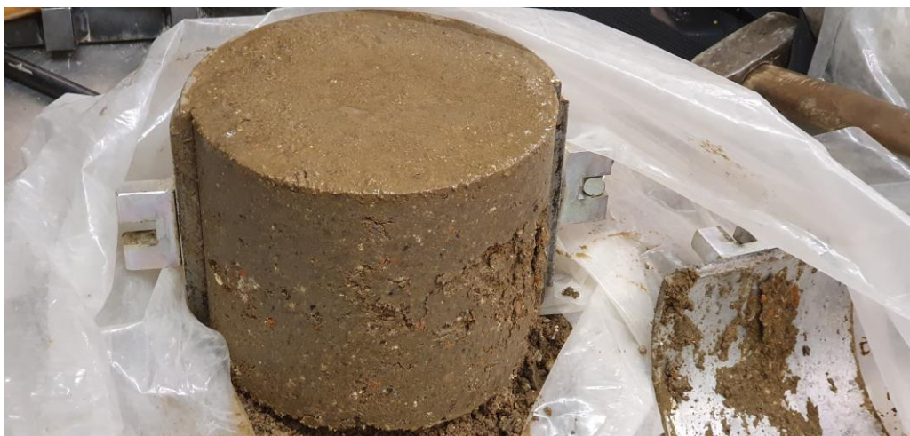
Obr. 64 Rozebrání formy typu B, Saturevaný vzorek směšného recyklátu s jílem
