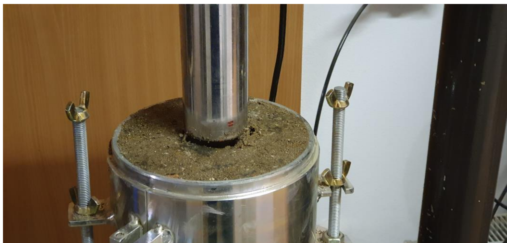
Obr. 61 Ukončení zkoušky IBI, Směsný recyklát s hlínou
