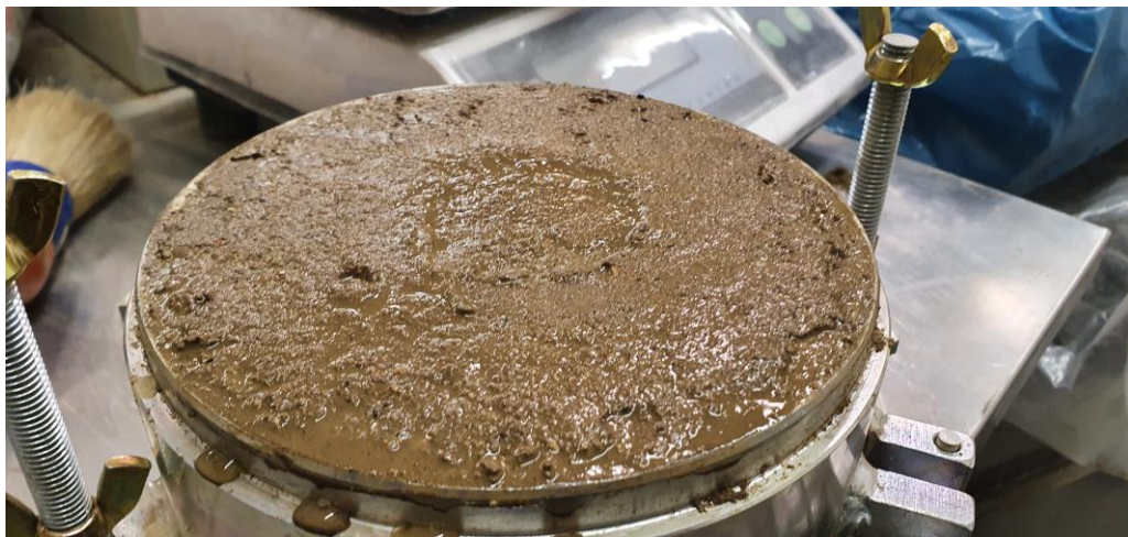
Obr. 63 Saturevaný vzorek směšného recyklátu s jílem po penetraci, zkouška CBR
