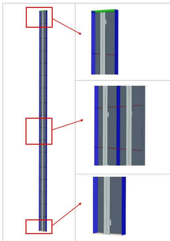
Obr. 4 Geometrie větrané mezery. Běžová = vstup vzduchu u paty. Zelená=výstup vzduchu u atiky, červená=mezery mezi obkladem, modrá=symetrická podmínka. Pravý prostřední obrázek okazuje model se zapnutou symetrií.
