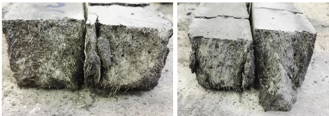
Obr. 35 a 36 (zleva): Viditelné nezhydratované pojivo proteplených vzorků po 60 dnech zrání receptur s množstvím cementu 800 \text{ kg/m}^3 a 1200 \text{ kg/m}^3
