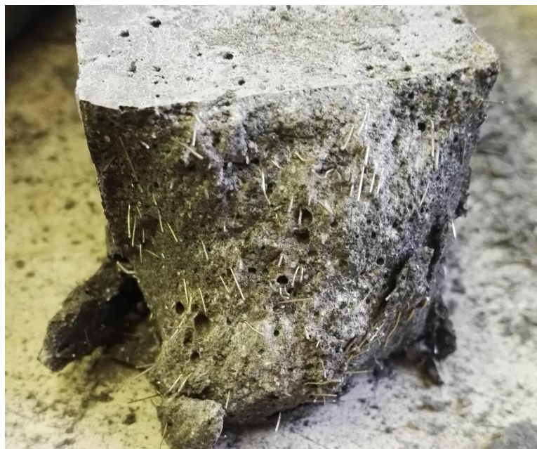
Obr. 37: Viditelné póry ve struktuře RPC po 60 dnech zrání
