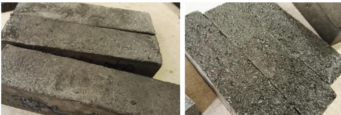
Obr. 29 a 30 (zleva): Rozdíl mezi povrchem zkušebního tělesa s použitím křemičitého písku frakce do 0,5 mm a s použitím písku frakce do 4 mm
