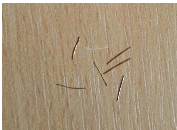
Obr. 19 a 20: Ocelová mikroválkna od výrobce Krampe Harex použitá pro výrobu RPC
