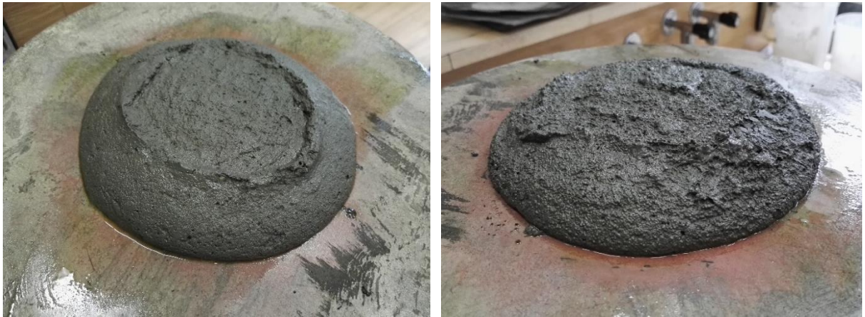
Obr. 33 a 34 (zleva): Rozlití RPC receptury 1.2 a receptury 1.3
