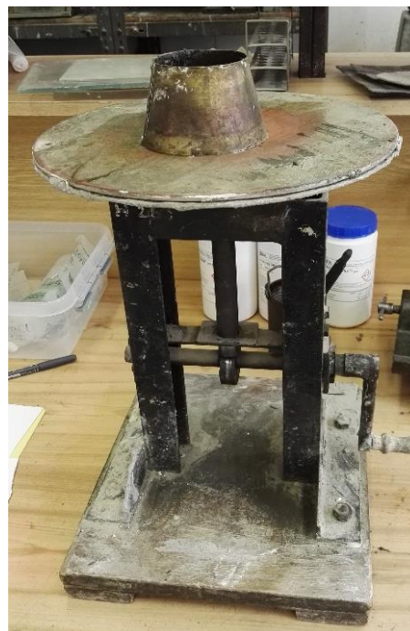
Obr. 23 a 24 (zleva): Rozměry kužele pro zkoušku rozlití RPC [80] a použitý střešací stolek pro provedení této zkoušky
