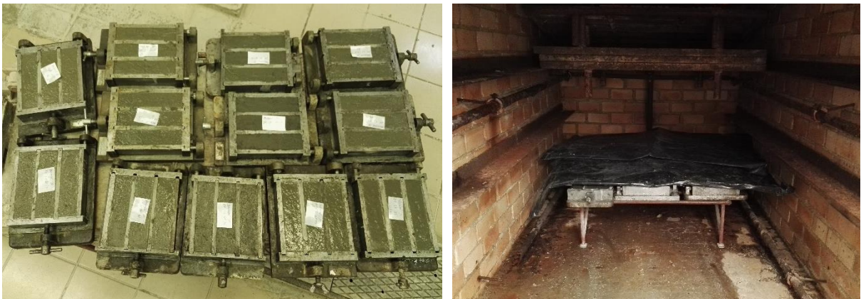
Obr. 27 a 28 (zleva): Čerstvý RPC uložený ve formách a uložení forem do propařovací komory před proteplením zkušebních těles
