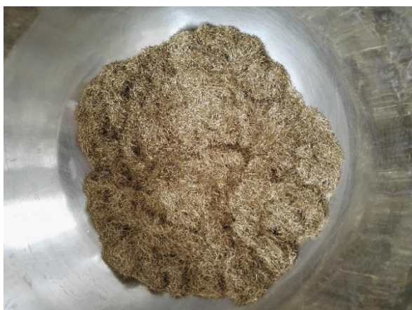
Obr. 19 a 20: Ocelová mikroválkna od výrobce Krampe Harex použitá pro výrobu RPC
