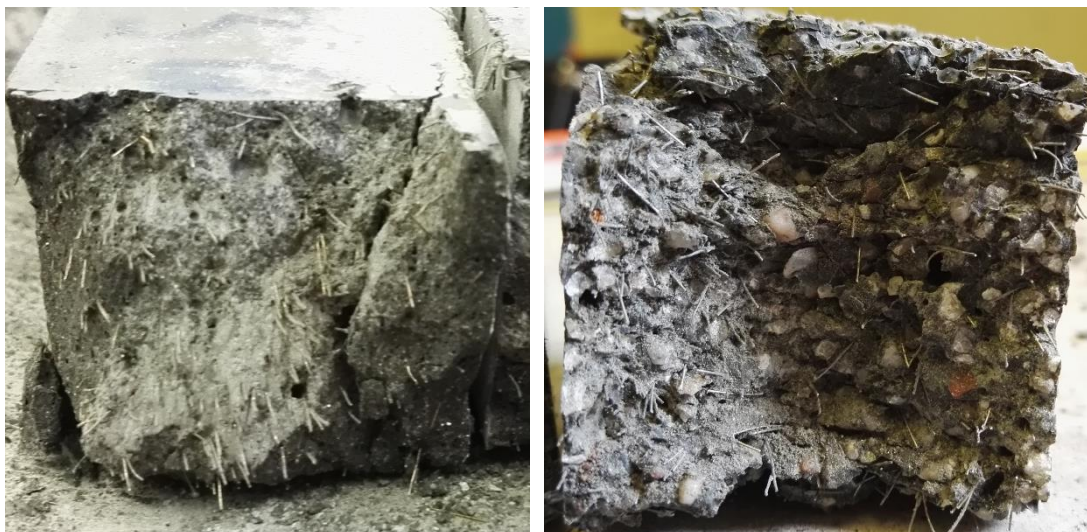
Obr. 31 a 32 (zleva): Porovnání struktury ztvrdlého RPC v případě receptury s frakcí křemičitého písku do 0,5 mm a s frakcí do 4 mm
