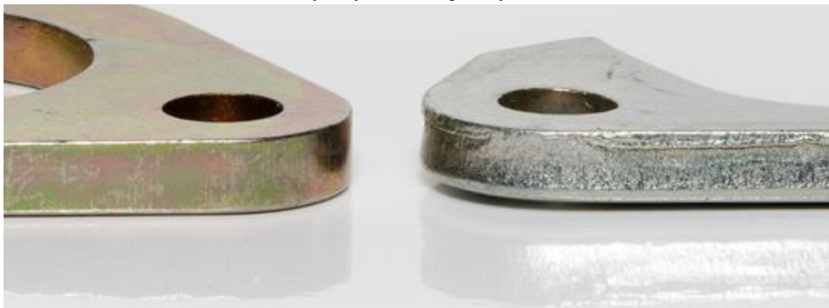
Obr. 2 Rozdíl mezi součásti zhotovenou přesným stříháním a běžným stříháním [5]
