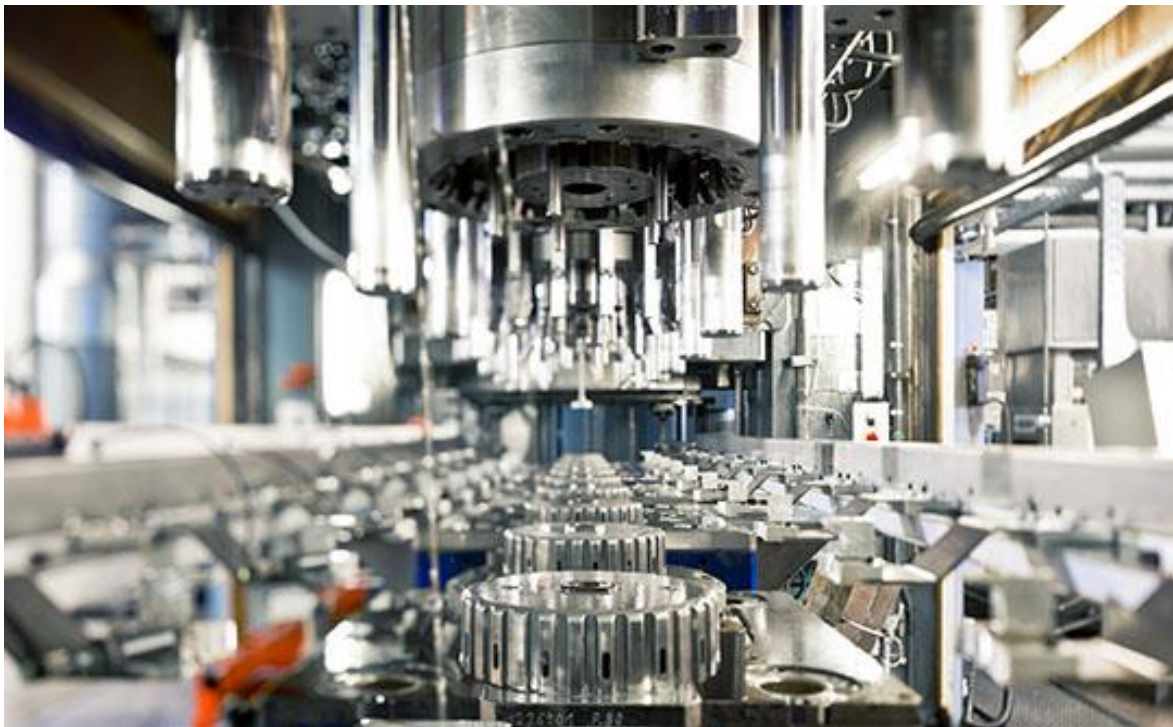
Obr. 1 Proces výroby součásti přesným stříháním [17]
