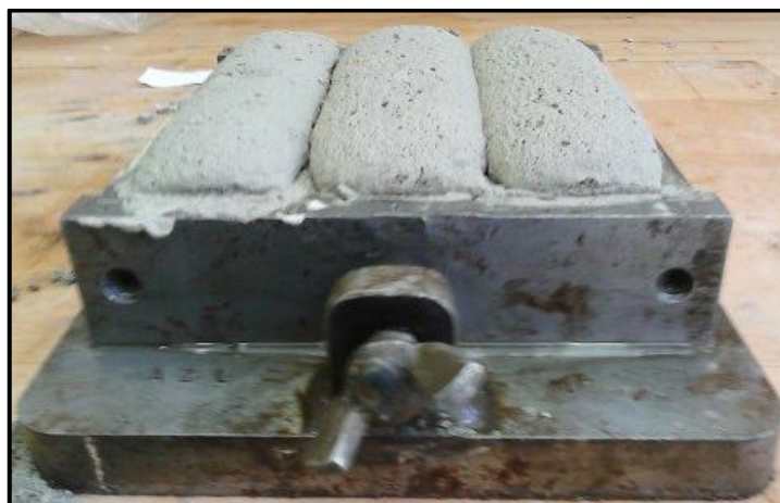
Obrázek 33 - Čerstvá směs chlorového vápna a peroxidu vodíku [foto:autor]
