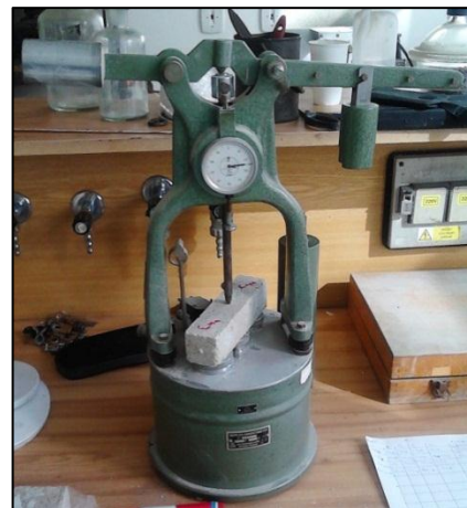
Obrázek 27 - Höpplerův konzistomer [foto:autor]
