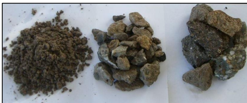
Obrázek 22 - Různé frakce betonového recyklátu [21]
