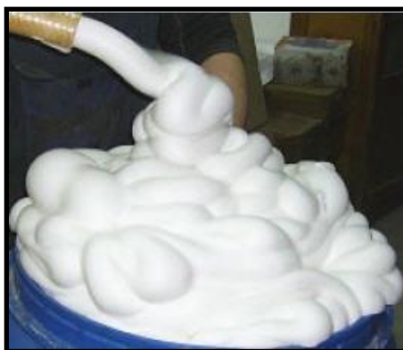
Obrázek 11 - Pěna z pěnidla Sika SB2 [32]
