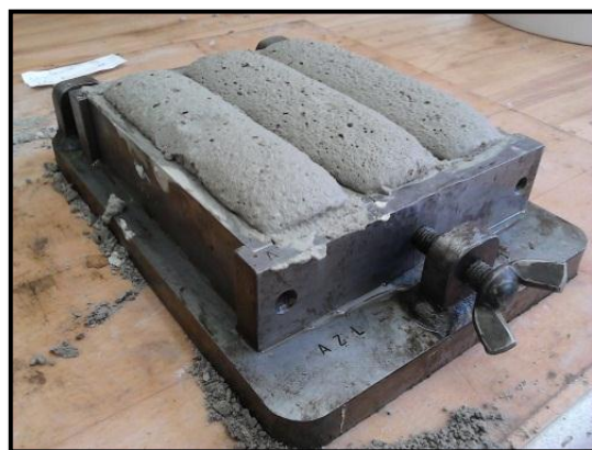
Obrázek 31 - Směs po nakynutí [foto:autor]
