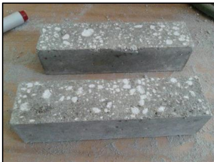
Obrázek 34 - Shluky vápenatých produktů [foto:autor]
