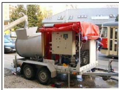
Obrázek 10 - Stroj pro výrobu pěny na stavbě [25]
