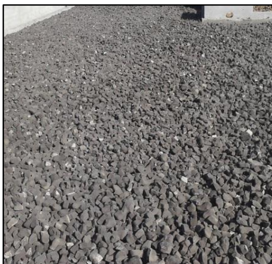
Obrázek 20 - Plnivo Refaglass připravené pro průmyslovou podlahu [19]
