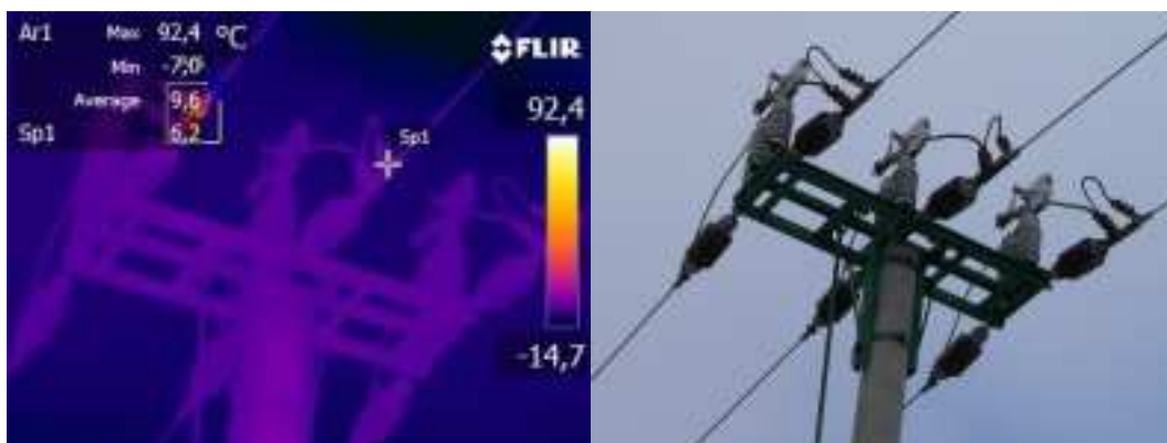
Obr. 0-12 Oteplení vinutí tlumivky
