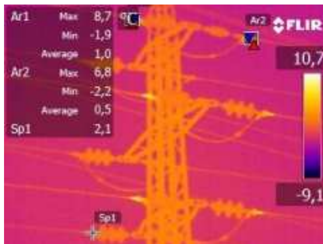
Obr. 4-2 Oteplení kotevních svorek
