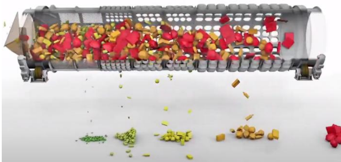
Obrázek 4: Princip bubnové separace [10]
