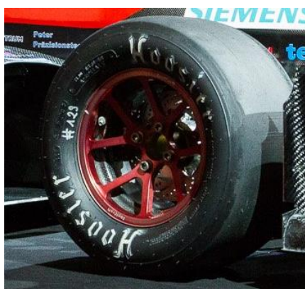
Obrázek 14 – Kolo vlastní výroby týmu High Octane Motorsports [16]
