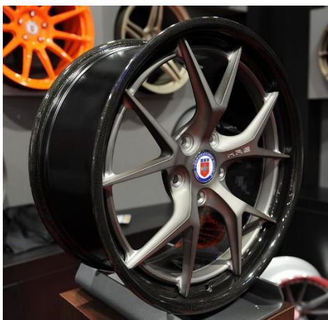
Obrázek 12 – Semikarbonové kolo HRE [15]
