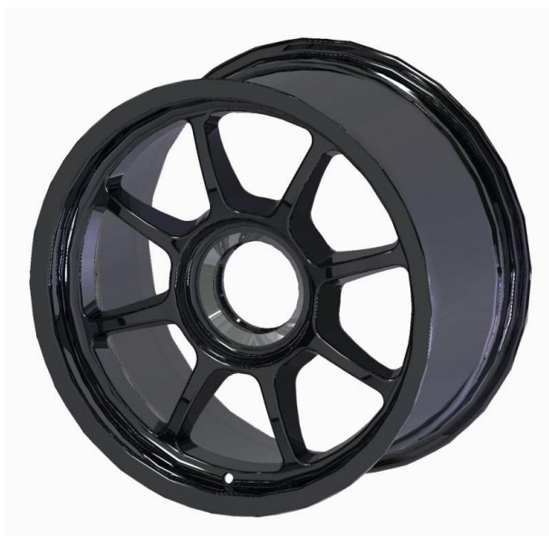
Obrázek 26 – Render modelu hoříkového kola OZ Racing
