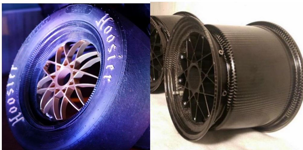
Obrázek 16 – Semikarbonová kola týmu DHBW Engineering Stuttgart e.v. [17]
