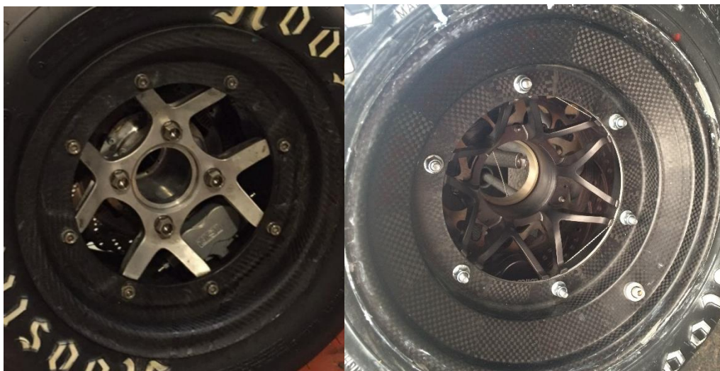
Obrázek 15 – Semikarbonová kola týmu Rennteam Stuttgart e.v. a UNI Erlangen
