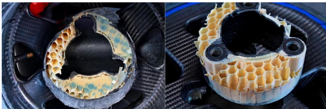
Obrázek 23 – havárie celokarbonového kola týmu CTU CarTech [25]
