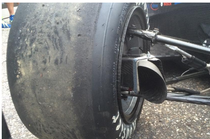
Obrázek 22 - Konfuzor pro chlazení brzd týmu TU Graz
