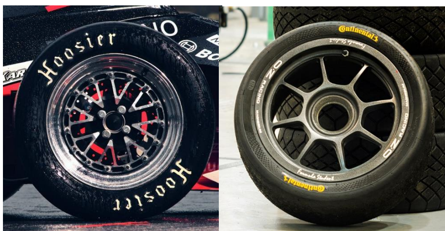
Obrázek 13 – Hliníkové kolo značky Keizer; Hořčíkové kolo značky OZ Racing
