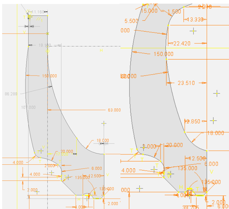
Obrázek 30 – profil diskové části kol; vlevo navrhované CFRP kolo, vpravo OZ Racing
