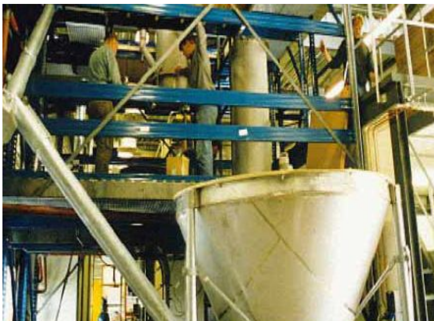
Obr. 4-3 Pilotní pyrolýzní jednotka na biomasu s kapacitou výroby bio-oleje 5t / den [7]
