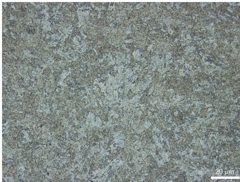
Obr 4.39 Detail mikrostruktury – základní materiál, střední část svaru, výchozí stav po žhání PWHT [29]
