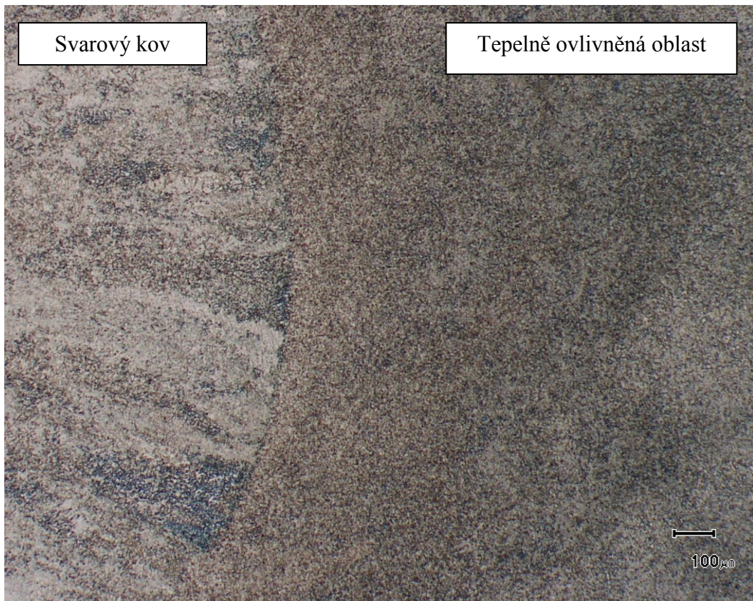
Obr. 4.18 Mikrostruktura TOO ve středové části, zvětšení 50x
