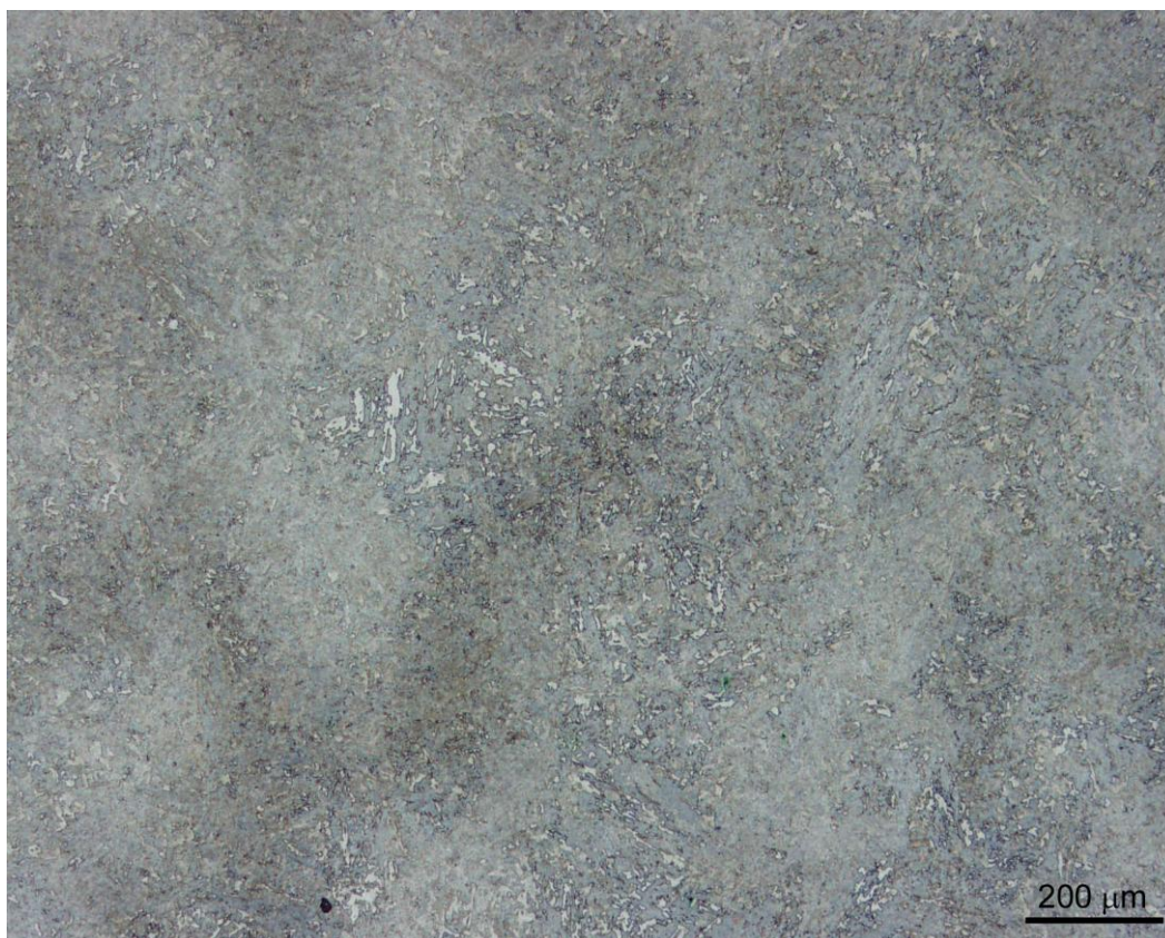
Obr. 4.14 Mikrostruktura ZM v lící části, zvětšení 50x
