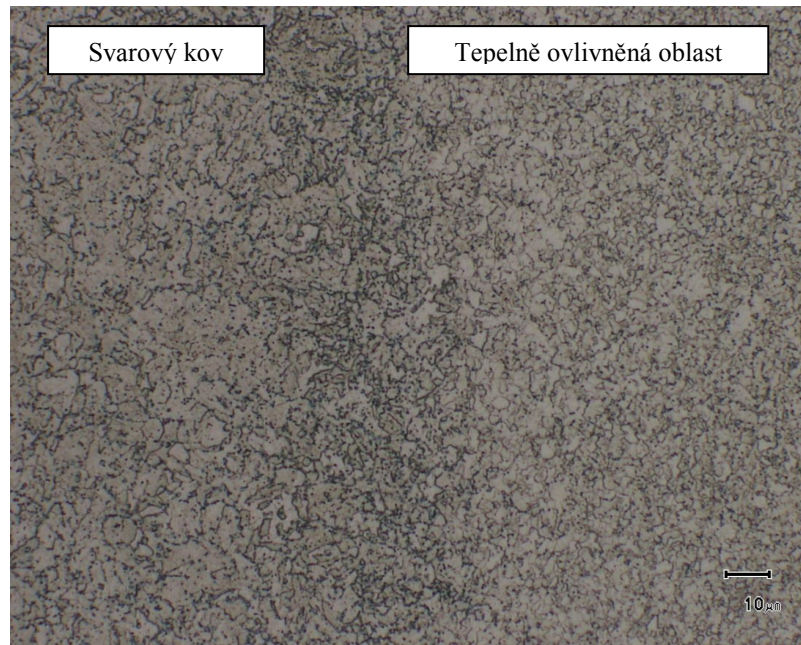
Obr 4.36 Detail mikrostruktury TOO, kořenová strana svaru, stav po umělé degradaci
