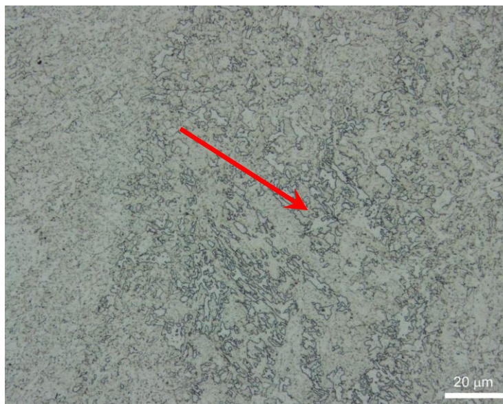
Obr 4.35 Detail mikrostruktury svarového kovu, lící strana svaru, výchozí stav po žihání PWHT [29], šipka označuje feritickou fázi
