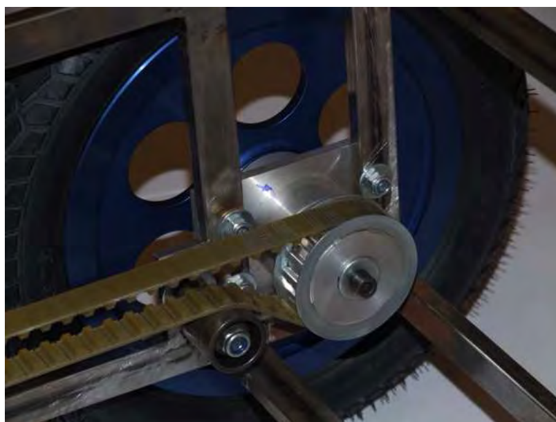
Obrázek 4.13: Detail napínání řemene
