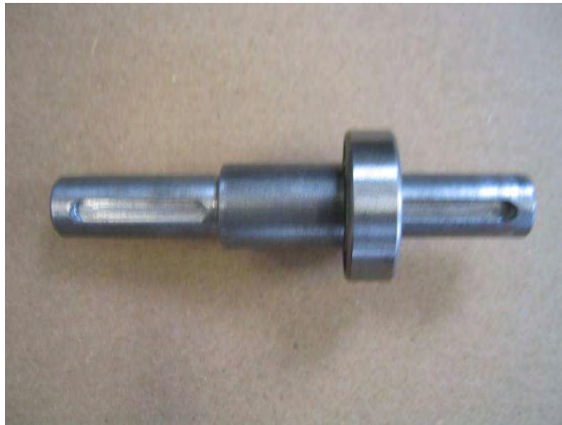
Obrázek 4.8: Hřídel s nalisovaným ložiskem
