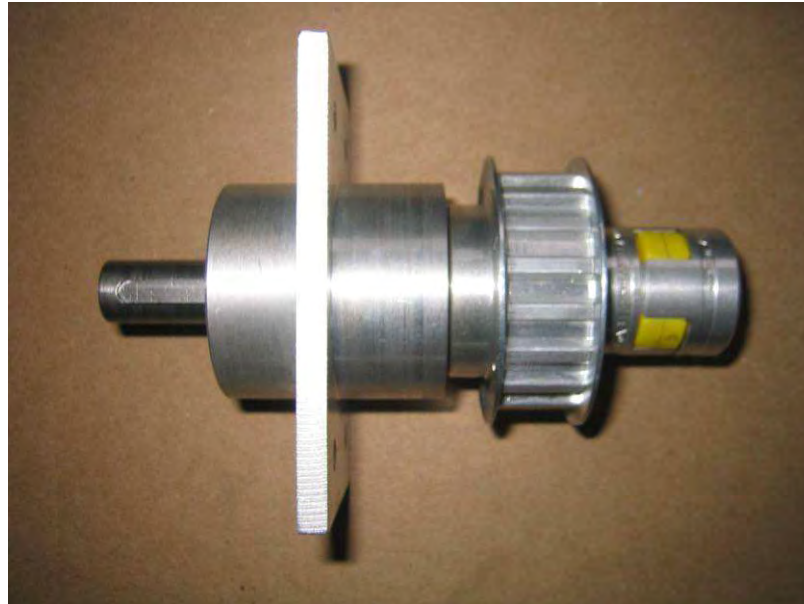
Obrázek 4.12: Celková sestava náboje, hřídele, spojky a řemenice
