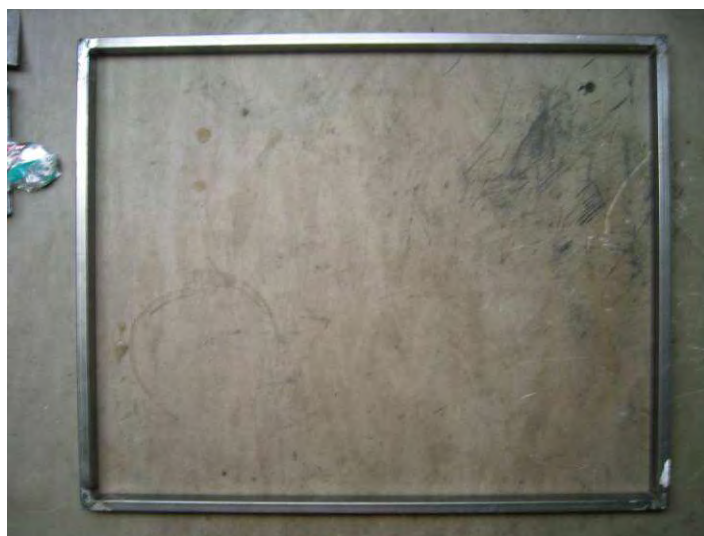
Obrázek 4.2: Svařené profily do tvaru obdélníku
