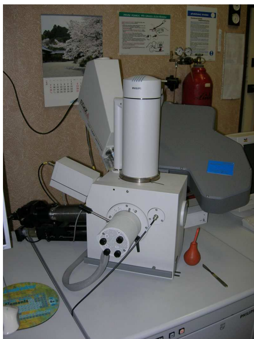
Obr. 49: Rastrovací elektronový mikroskop s EBSD detektorem.
