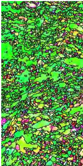
Obr. 72: Mikrostruktura po ECAP procesu před únavovým namáháním – T-řez.
