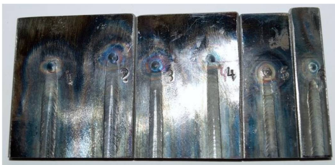
Obr. 31 Vzorky S235JR [vl. tvorba]
