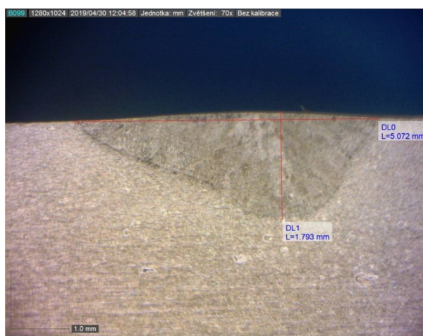
Obr. 38 x5CrNi1810 svar 6 [vl. tvorba]
