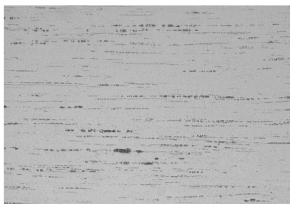
Obr. 16 W-elektroda s oxidy thoria [22]
