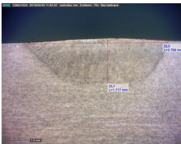
Obr. 35 x5CrNi1810 svar 3 [vl. tvorba]
