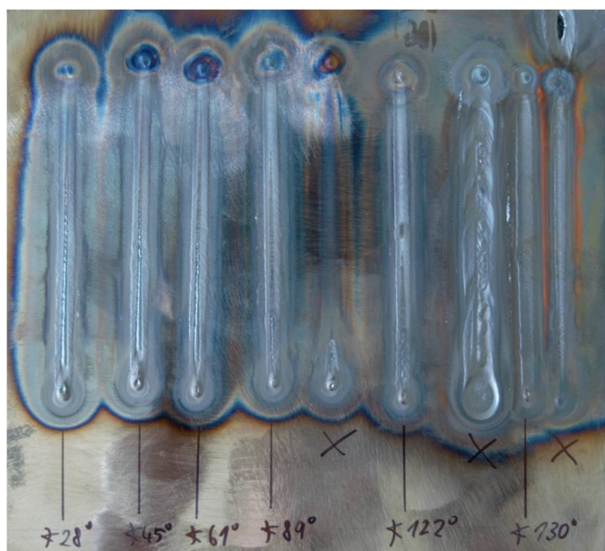
Obr. 28 Svary na S235JR [vl. tvorba]
