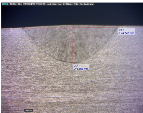
Obr. 37 x5CrNi1810 svar 5 [vl. tvorba]
