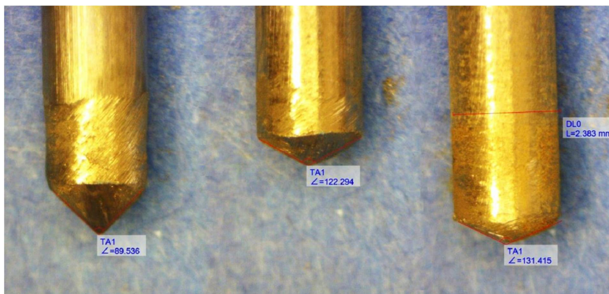
Obr. 27 Nabroušené w-elektrody 2 [vlastní tvorba]
