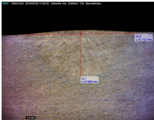
Obr. 33 x5CrNi1810 svar 1 [vl. tvorba]
