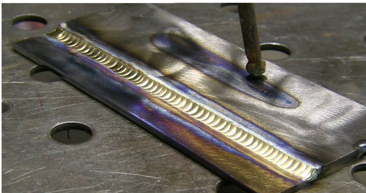
Obr. 3 Ukázka svaru zhotoveného metodou TIG [3]
