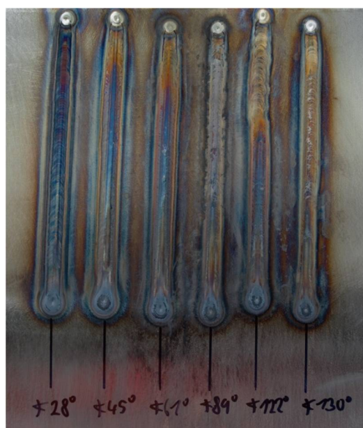
Obr. 29 Svary na x5CrNi1810 [vl. tvorba]
