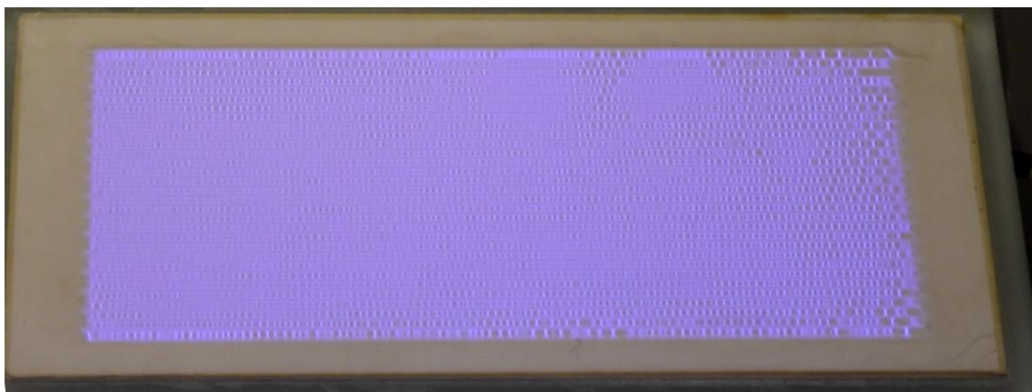
Obrázek 39: DCSBD výbojka při příkonu 400 W a pracovním kmitočtu 15 kHz
