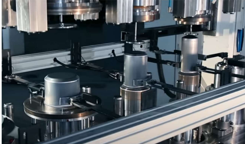
Obr. 10 Hluboké tažení na postupovém automatu [20].
