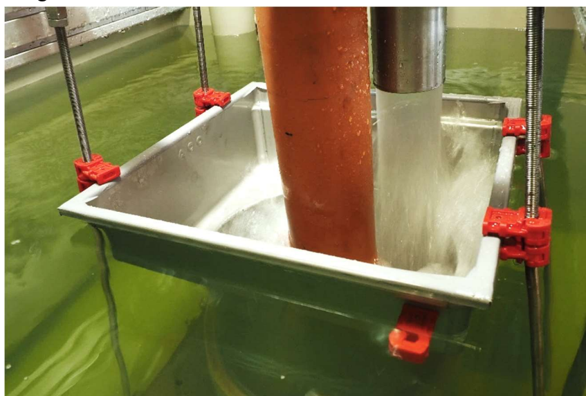
Obr. 61 Zkouška průtoku vpustí metodou přímého nátoky.
