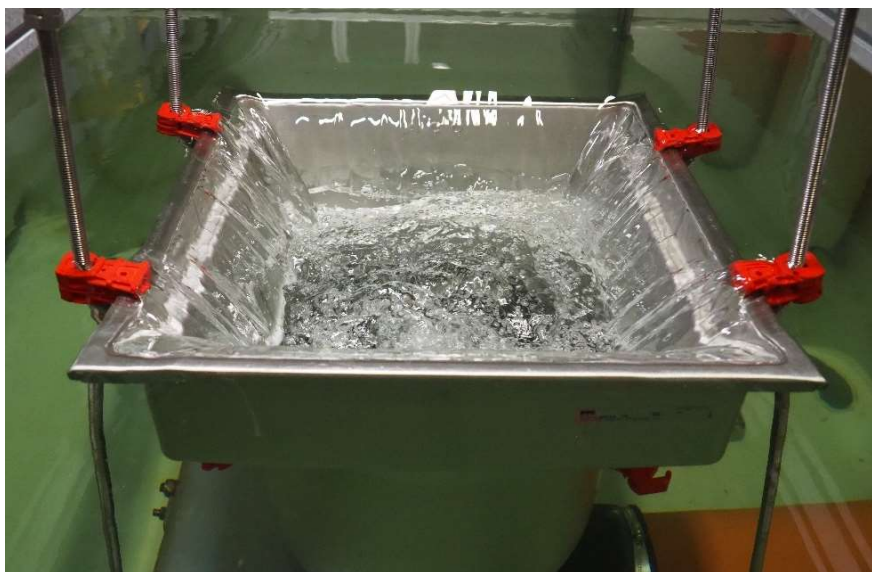
Obr. 55 Zkouška průtoku vpusti dle ČSN EN 1253-1.
