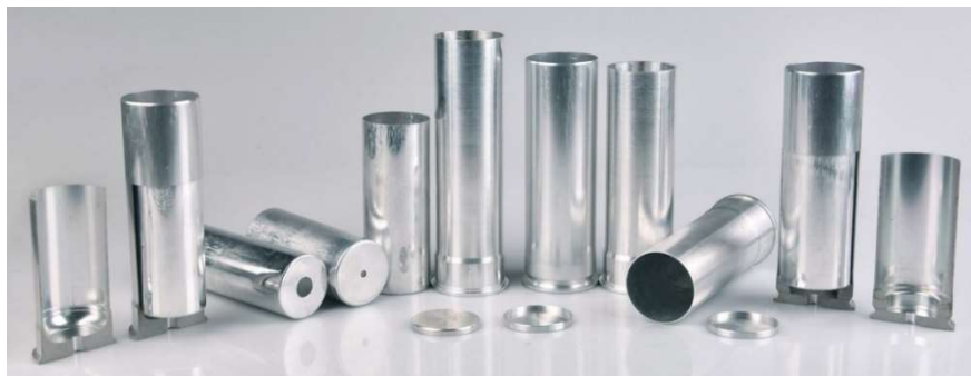
Obr. 7 Zpětné protlačování dutých nádob [18].
