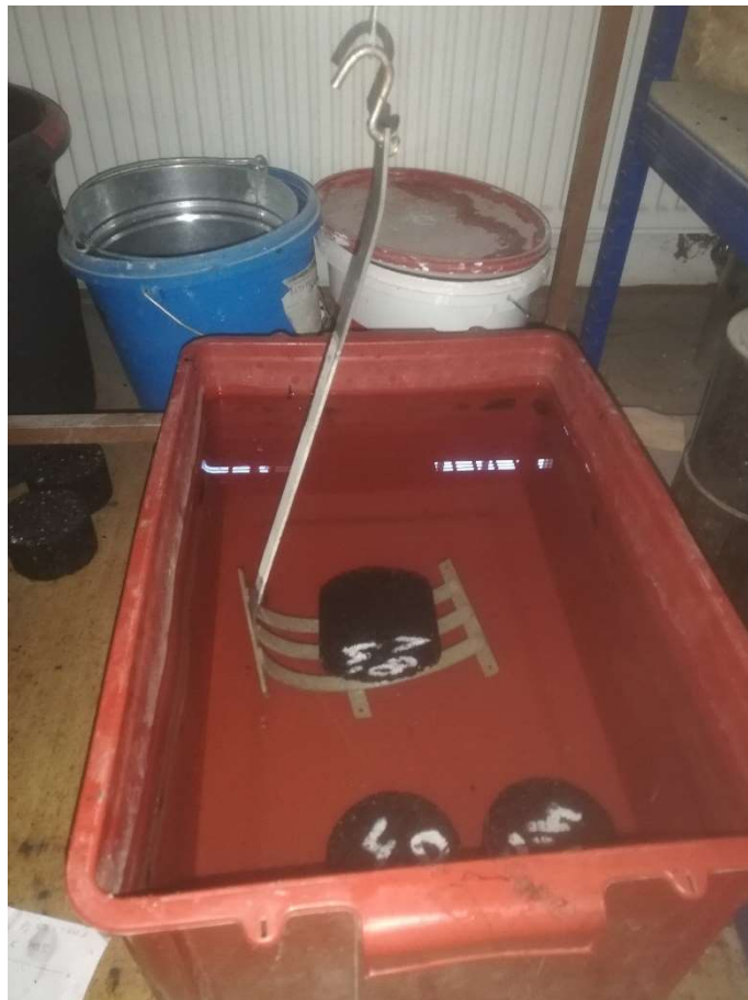
Obrázek č. 6: Stanovení objemové hmotnosti hydrostatickým vážením
