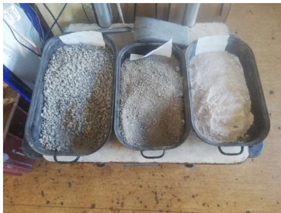
Obrázek č. 12: použitý materiál (z leva: kamenivo frakce 4/8, kamenivo frakce 0/4, Filer)
