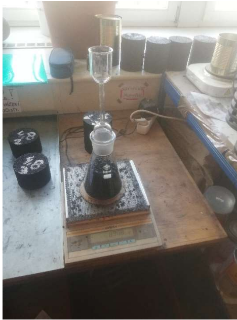
Obrázek č. 7: Zkoušený vzorek s pyknometrem
