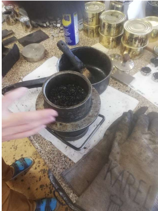
Obr. č 16: Směs ve formě na Marshallova tělesa
