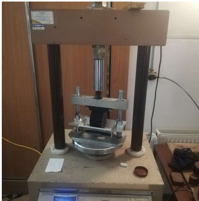
Obrázek č. 19: Zkouška pevnosti v příčném tahu.
