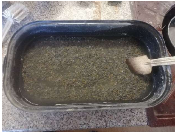
Obrázek č. 3: Odplavení jemných částic
