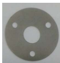
Obr. 6 Plechový kroužek pro konstrukci chladicího kanálu
