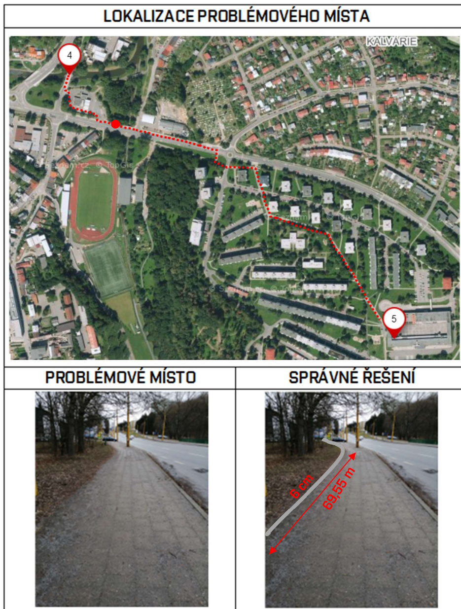
Obrázek 48 - zřízení vodící linie na trase most U Jánů - pošta
