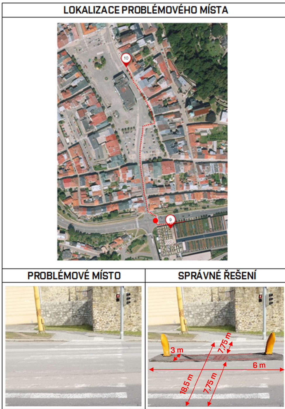
Obrázek 62 - zřízení dělicího ostrůvku na trase DC Citypark - magistrát
