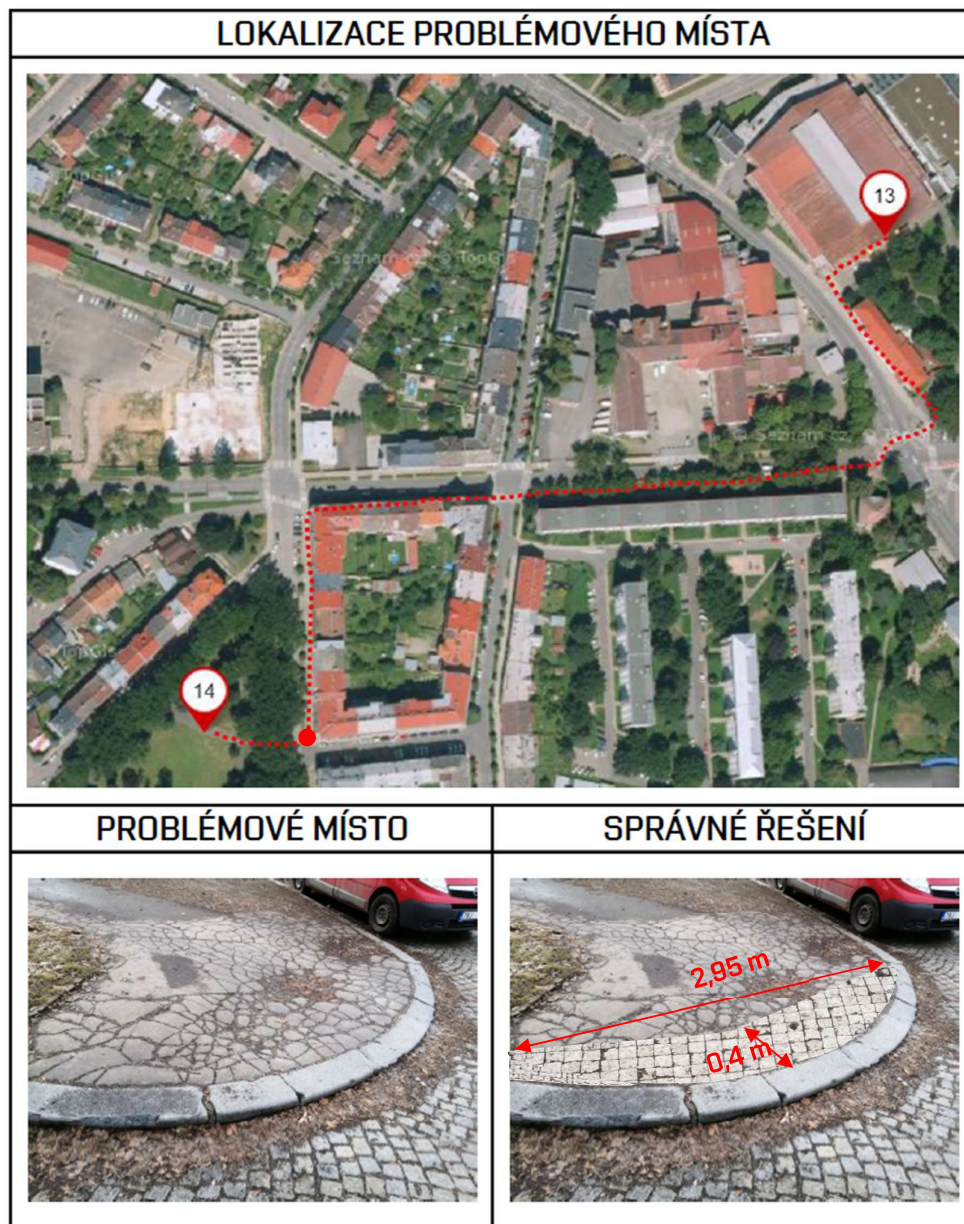
Obrázek 75 - zřízení varovného pásu na trase hokejový stadion - park M. R. Štefánika
