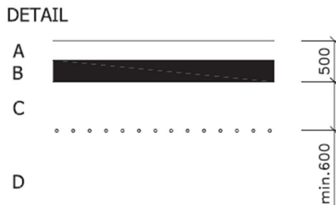
Obrázek 29 - Detail nástupiště autobusové, trolejbusové zastávky
