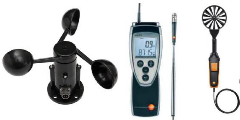
Obr. 2 Mechanické anemometry zleva: miskový, vrtulkový, lopatkový [4]
