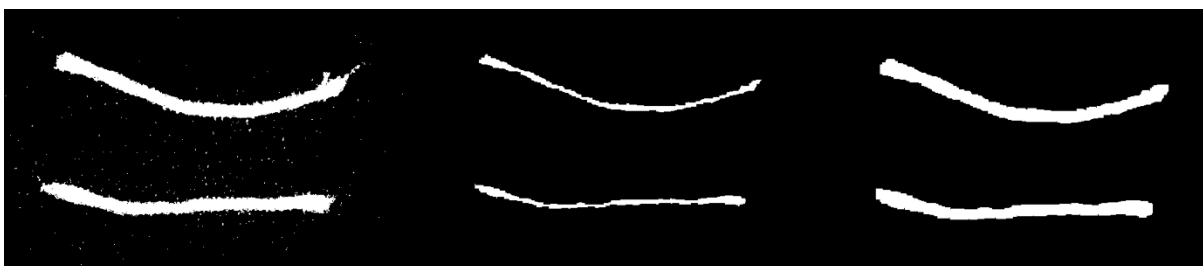
Obr. 32 zleva: maska se šumem, vliv eroze, vliv dilatace
