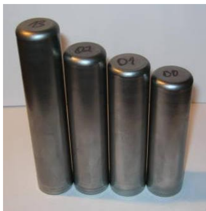
Obr. 7.2 Výtažky pro měření tvrdosti – zleva: HT179-13, HT179-02, HT179-01, HT179-00
