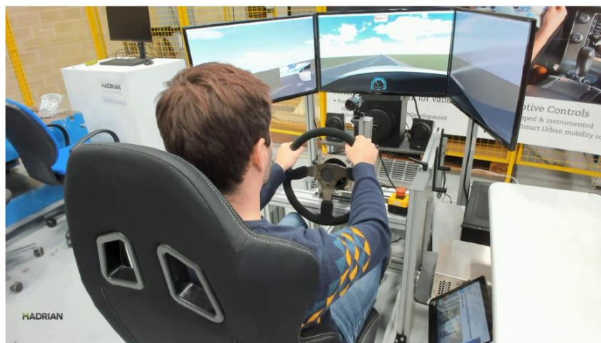
Obrázek 23: Studie řídicího simulátoru s haptickým volantem [10]
