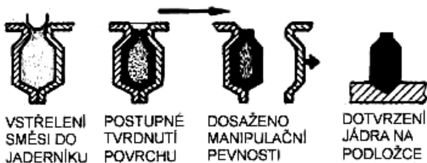
Obr. 2.3 Postup tvrdnutí jádra [3]
