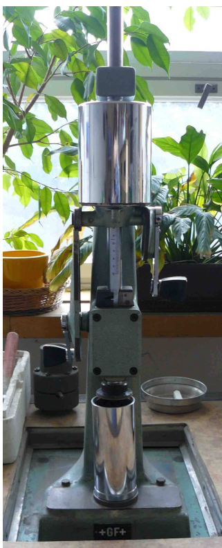
Obr. 3.4 Příklad přístroje na pěstování zkušebních tělísek
