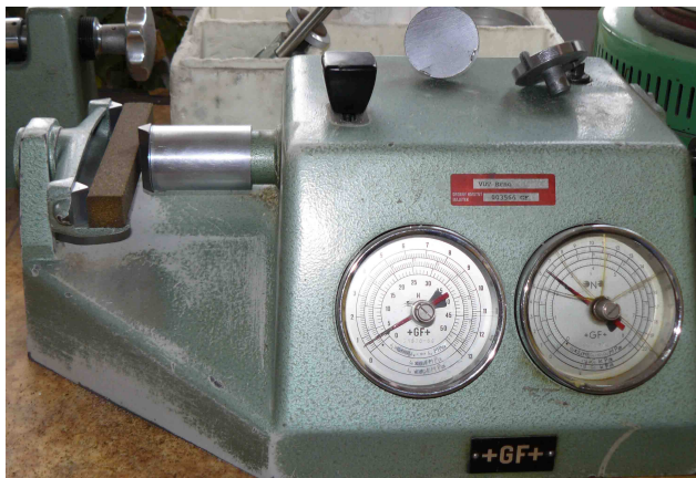
Obr. 3.7 Univerzální přístroj na měření pevnosti +GF+
