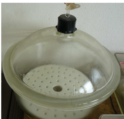
Obr. 3.9 Exsikátor na měření navlhavosti
