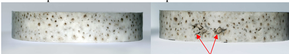
Obr. 4 Vzorek č. 53 (vlevo) bez porušené povrchové struktury a vzorek č. 44 (vpravo) s porušenou strukturou povrchu
