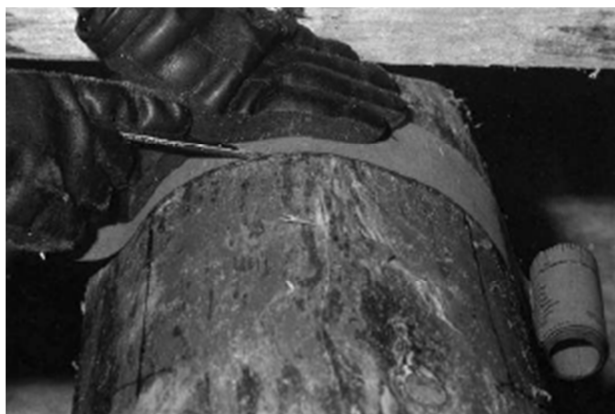
Obr. 4.10 Konečné dokreslení pomocí pásky [14]
