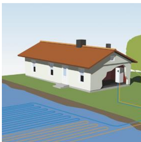
Obrázek 11 Tepelné čerpadlo voda/voda, plošný kolektor [18]
