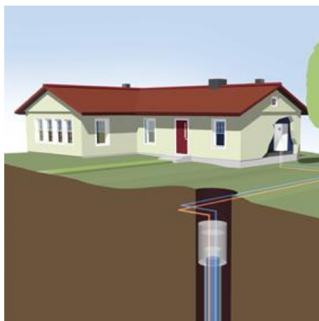
Obrázek 10 Tepelné čerpadlo země/voda, svislý kolektor [17]
