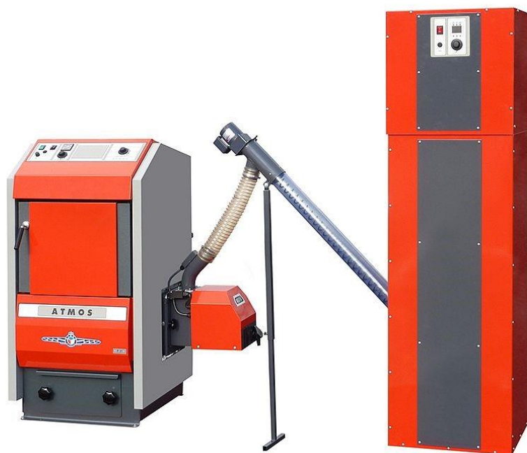
Obrázek 43 Kotel na pelety D30P s hořákem A45, šnekovým dopravníkem DRA50 a zásobníkem pro pneumatickou dopravu APS 250 [54]
