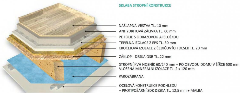
Obrázek 23 Skladba stropní konstrukce [41]
