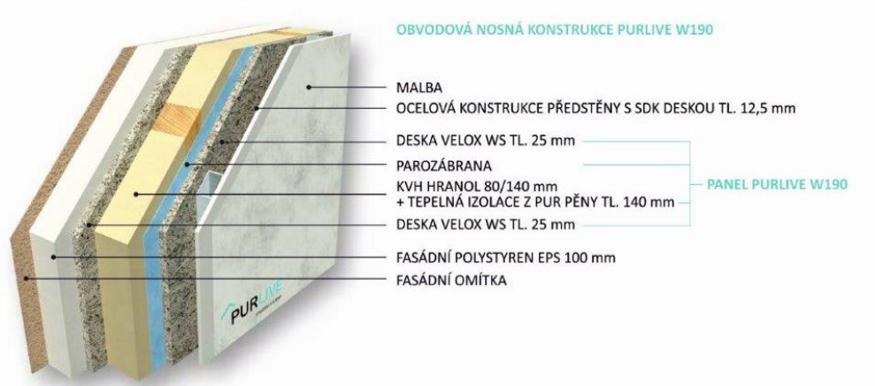
Obrázek 22 Skladba obvodové stěny PURLIVE W190 [41]
