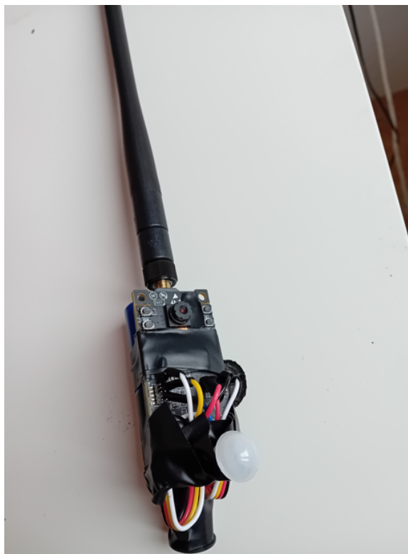
Obrázek 5.6: Prototyp s vývojovou deskou ESP32-S3-EYE.
