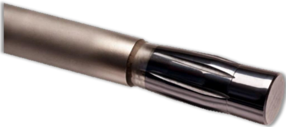
Obr. 37 Tvářecí trn – podle [30].
