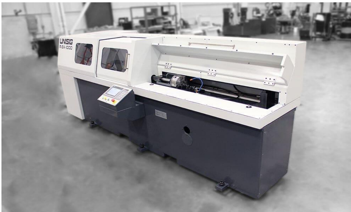
Obr. 39 Zařízení pro protlačování tvářecího trnu UNISIG R-2A 1000. [33]
