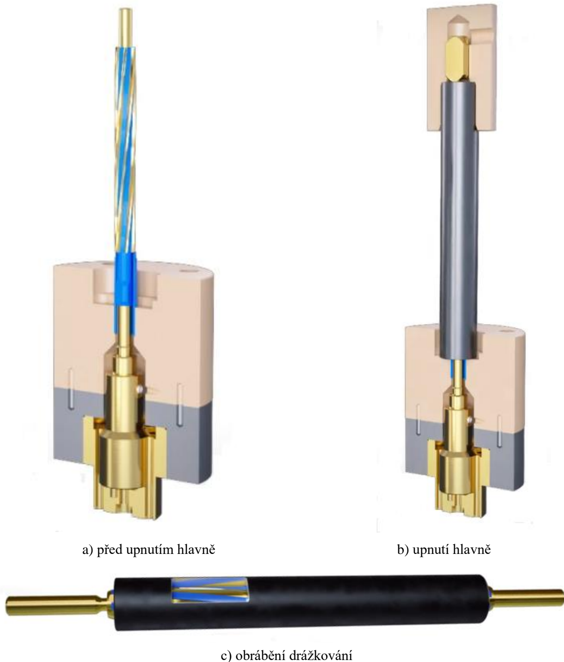
Obr. 45 Proces statického ECM drážkování – podle [37].
