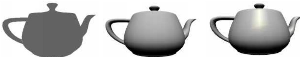
Obrázok 12: Osvetlenie rátaťie pre každý vrchol postupnou inkrementáciou jednotlivých zložiek [9].
