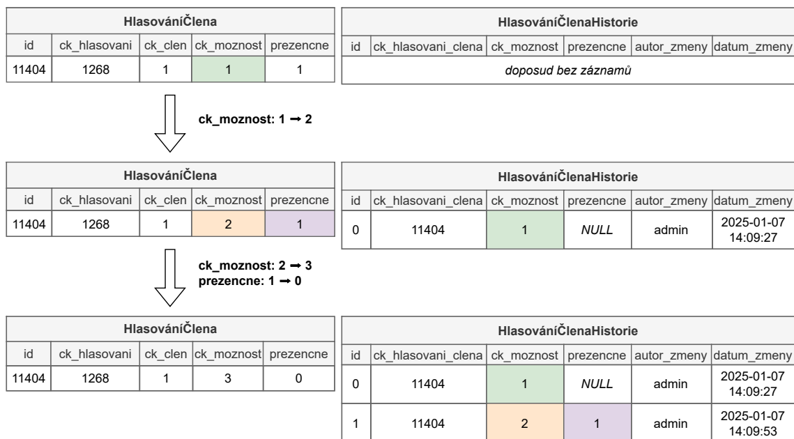
Obrázek 5.3: Princip ukládání historie změn záznamů sledovaných entit. Tabulky historie kopírují atributy upravitelné v grafickém rozhraní. Při úpravě takového atributu je předchozí hodnota před změnou uložena do historického záznamu. Nezměněné hodnoty se kvůli úspoře úložného prostoru neukládají. V obou vyobrazených tabulkách byly pro přehlednost zanedbány záznamy související s jinými hlasováními.
