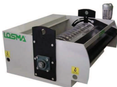
obr. 17 Magnetický filtr spol. Belmet [17]
