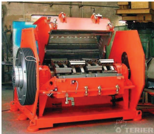
obr. 21 Hranový drtič společnosti Terier [14]
