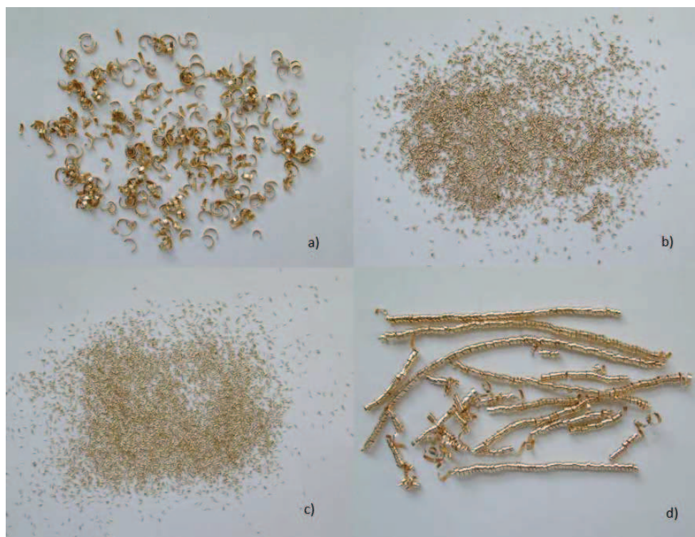
obr. 4 Utváření třísky při soustružení odlitků průměru 45 mm a) CuZn40Mg0,4P0,4 (P4), b) CuZn4Mg0,4P0,4Bi0,4 (P5), c) CuZn40Pb2, d) CuZn40 (P1).[19]
