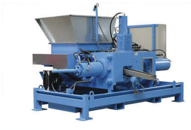
obr. 22 Briketovací lis BrikStar MR [21]
