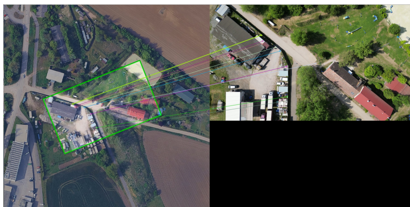
Obr. 9.8: Filtrované korespondence určené algoritmem ORB
