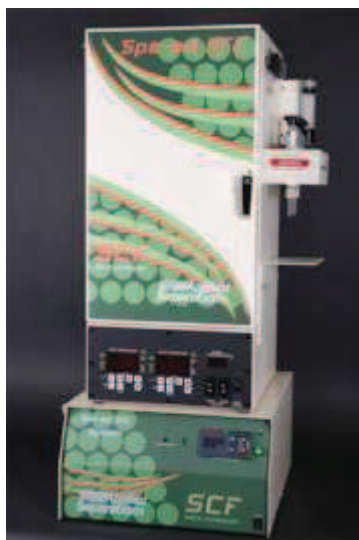
Obrázek 15: Příklad přístroje Spe-ed SFE-2 pro simultánní extrakci dvou vzorků [50]
