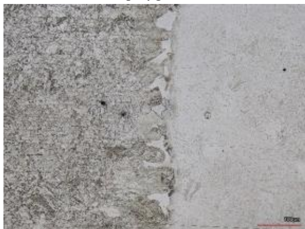
Obr. 48 Mikroštruktúra TOO a ZK oceli X12Cr13 [12].
