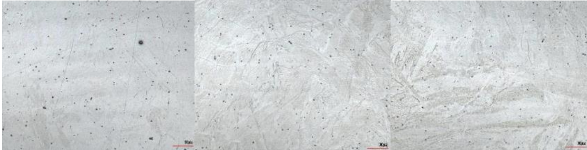
Obr. 47 Mikroštruktúra zváranj oceli X12Cr13 zľava povrch, hlava, koreň [12].
