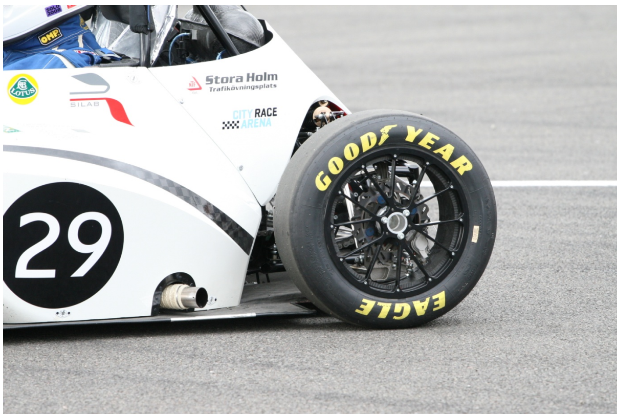
Obr. 9 Výfuk umístěný vedle řidiče
