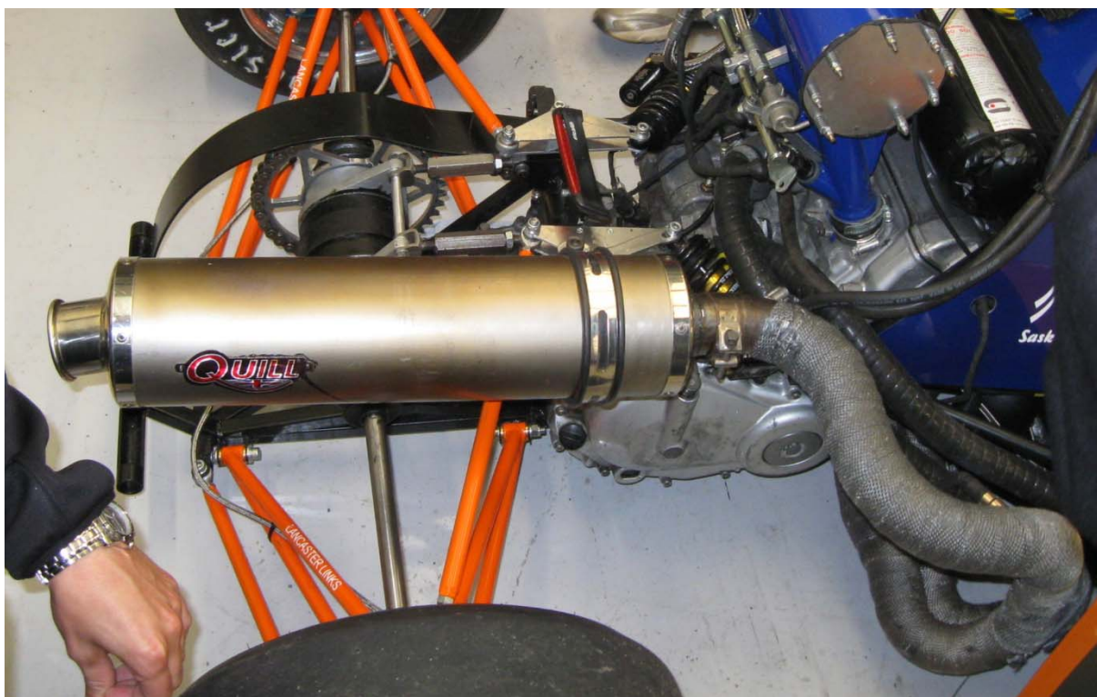
Obr. 6 Výfuk umístěný podélně nad nápravou
