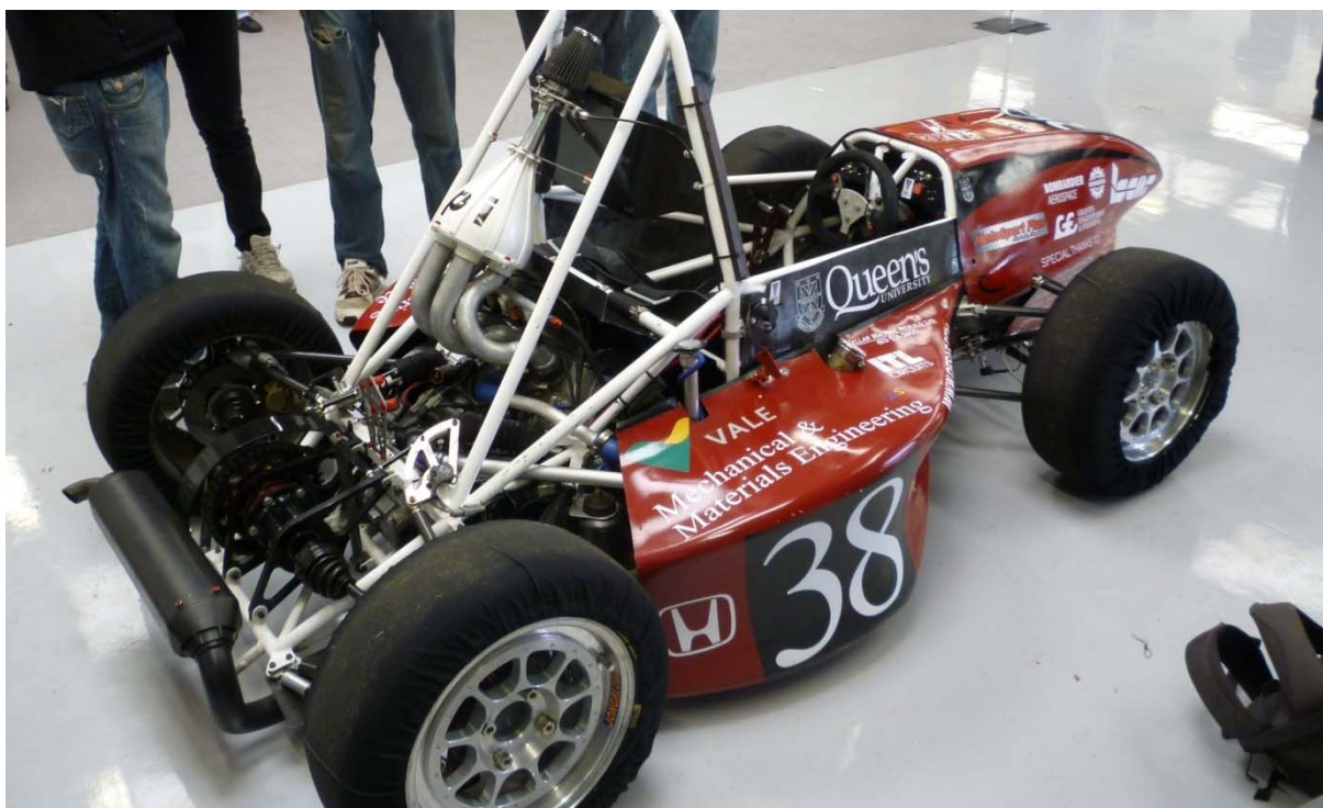
Obr. 7 Výfuk umístěný napříč
