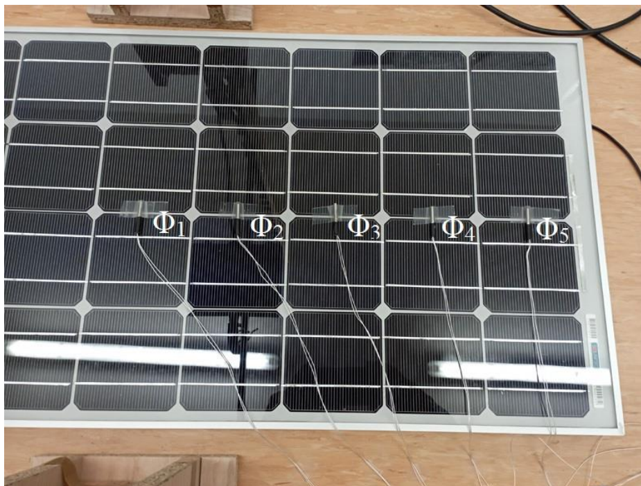
Obr. 5.36 Skúmaný panel s pripojenými snímačmi teploty
