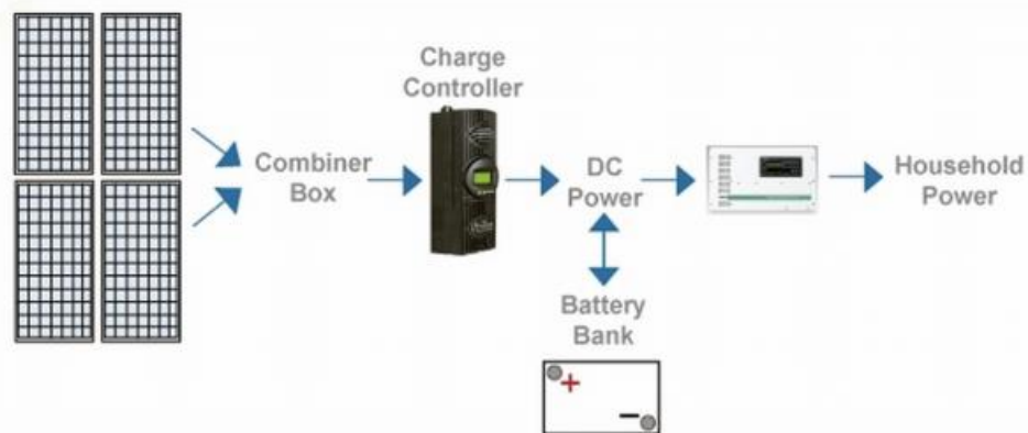
Obr. 1.2 Schéma autonómneho fotovoltického systému [5]
