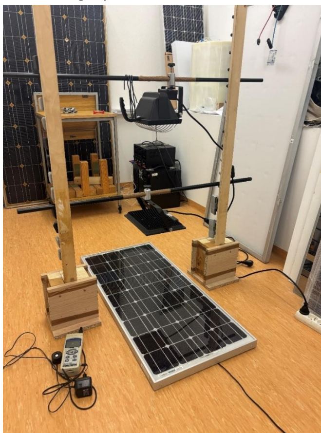
Obr. 5.5 Zostavené meracie pracovisko s fotovoltickým panelom, zdrojom svetla a meracím expozimetrom
