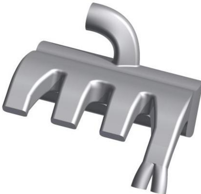
Obr. 18 Výsledný model sací soustavy
