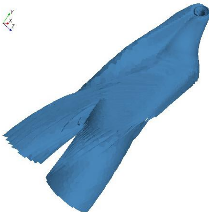
Obr. 29 Vizualizace proudění vefukovaného metanu – Varianta A
