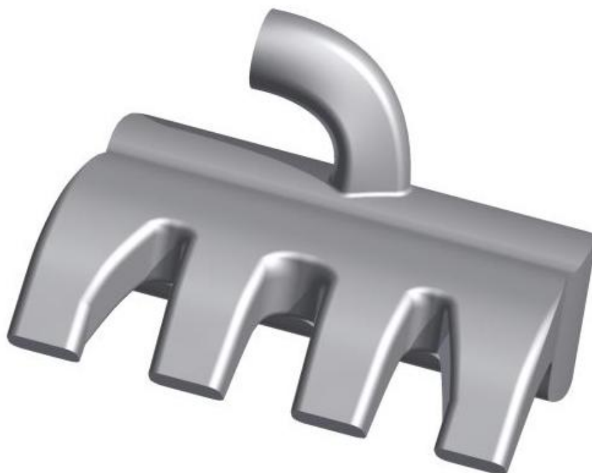
Obr. 16 Základní model "vzduchu" sacího potrubí
