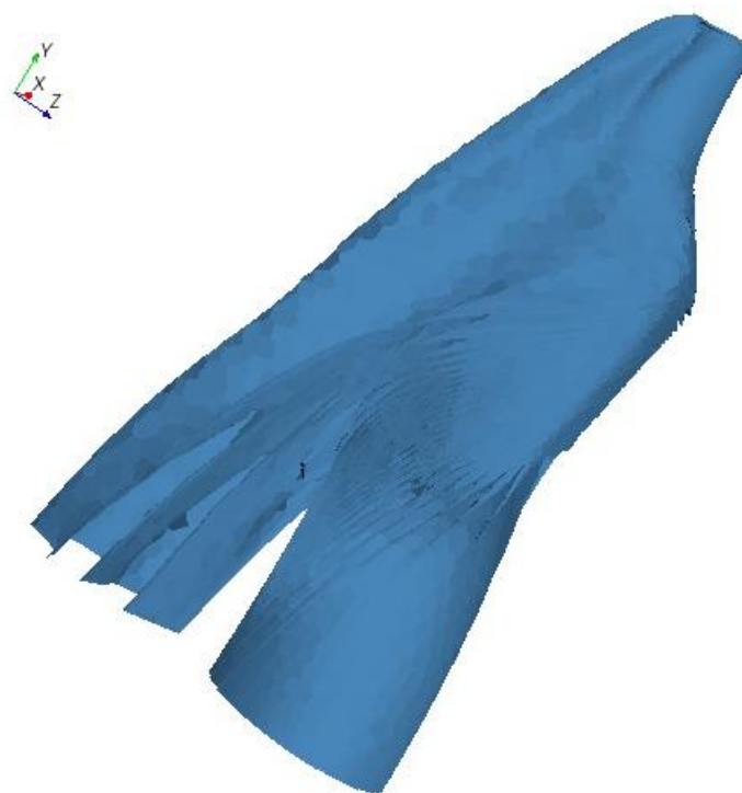
Obr. 32 Vizualizace proudění vefukovaného metanu – Varianta B
