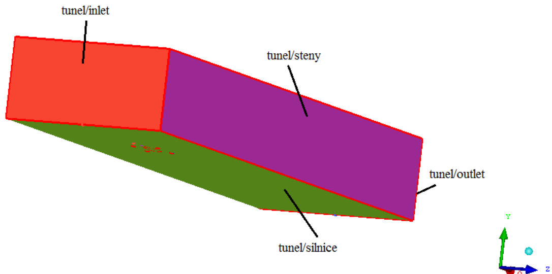
Obr. 25 Rozčlenění tunelu na jednotlivé Party
