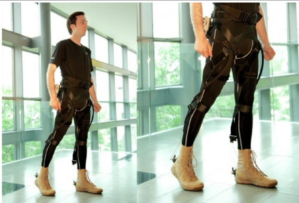
Obr. 8) Soft clothing-like exosuit s Bowdenovými lanky[6]
