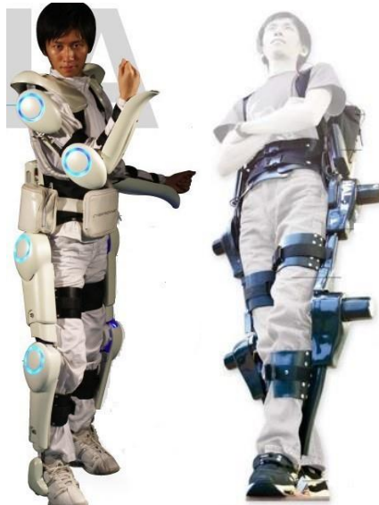
Obr. 12) Vývojové modely HAL – Model v.3 (vlevo) [17], Model v.5 (vpravo) [17]
