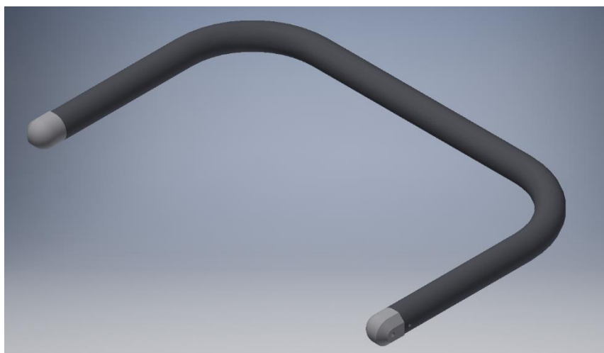
Obr. 40) Nosný profil hydraulického agregátu
