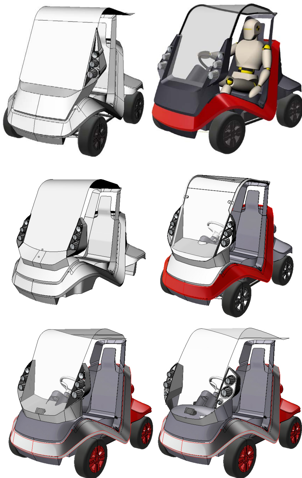
Obr. 6.34 Vývojové etapy proměny přední části. Idea předsazení objemu nad blatníky s následným odsazením ke sklu zcela potlačuje původní myšlenky oddělení dvou objemů i ústřední motiv (nahore). Návrh uprostřed vlevo pracuje s kontrastním navázáním ploch (konvexní plochy dole a konkávní prolomení sklo-plocha pod prosklením) a tím vytváří nesoulad i snižuje pohledovou tuhost.
