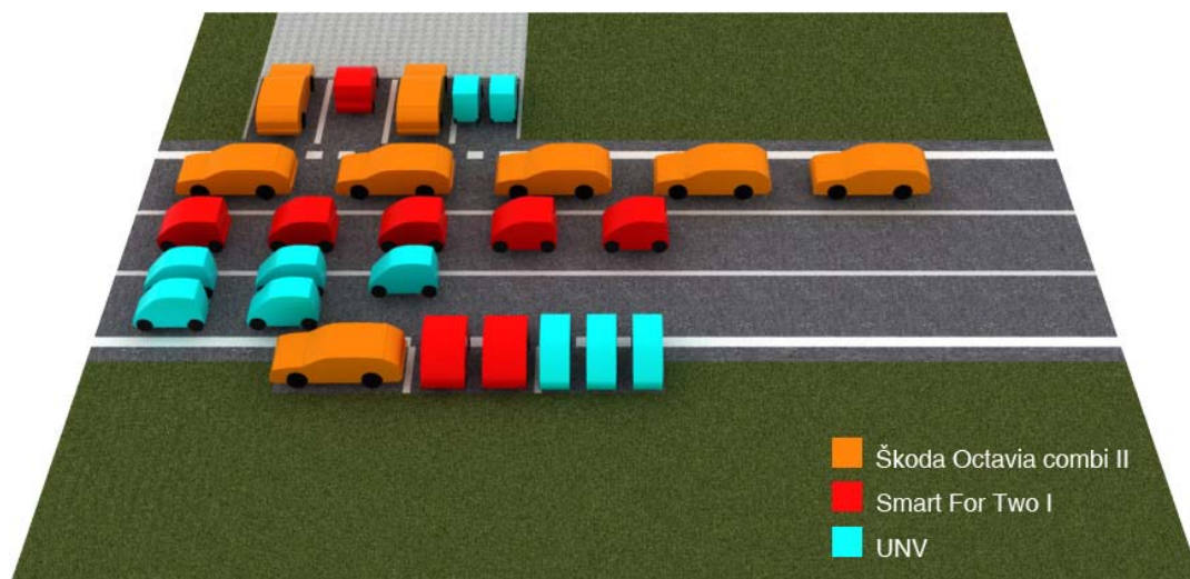
Obr. 2.24 Schema plošného obsazení komunikací vozidly v závislosti na jejich rozměrech v jízdních a přidružených pruzích (zálivy). Rozměry vozovky odpovídají ČSN 736110
