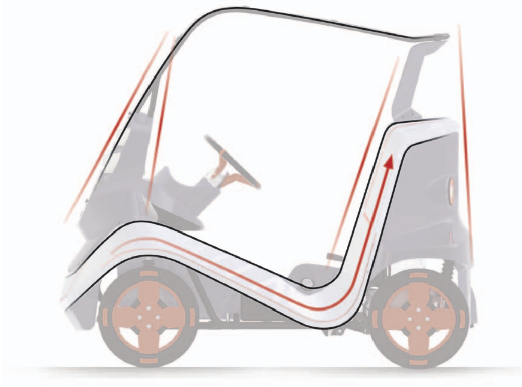
Obr. 6.47 Bokorys s vyznačením charakteristických křivek a zužování směrem vzhůru
