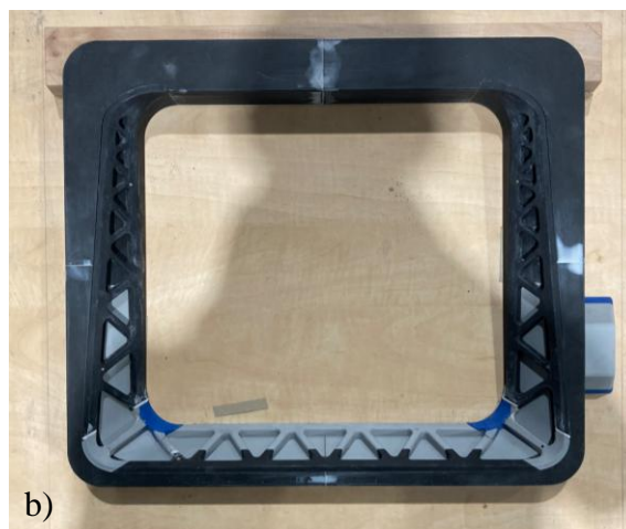
Obr. 5-1 a) Rozložený CAD model b) Složený slévárenský model
