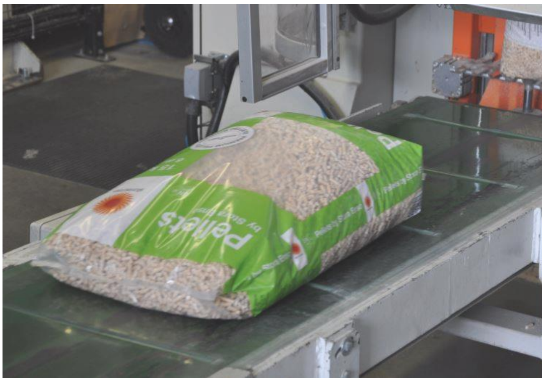
Obrázek 8: Balení pelet do sáčku po 15 kg[14]
