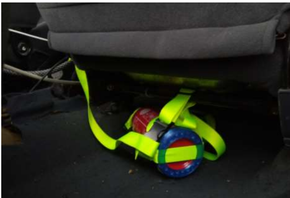
Obr. č. 30 - Upevnění hasicího přístroje ve vozidle Daewoo Matiz
