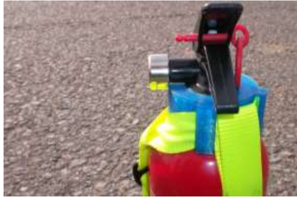
Obr. č. 28 - Hasicí přístroj upevněný pod sedadlem řidiče ve vozidle Škoda Fabia po crash testu
