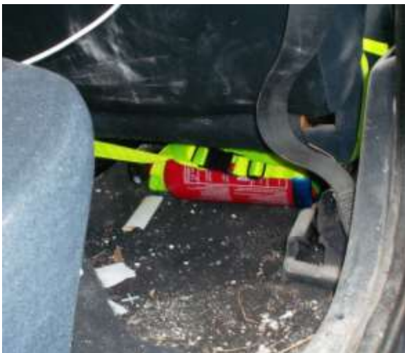
Obr. č. 37 - Upevnění hasicího přístroje ve vozidle Ford Escort před crash testem
