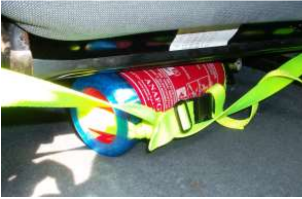
Obr. č. 28 - Hasicí přístroj upevněný pod sedadlem řidiče ve vozidle Škoda Fabia po crash testu
