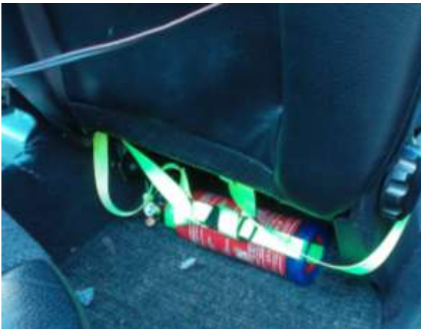
Obr. č. 29 - Upevnění hasicího přístroje ve vozidle Ford Mondeo
