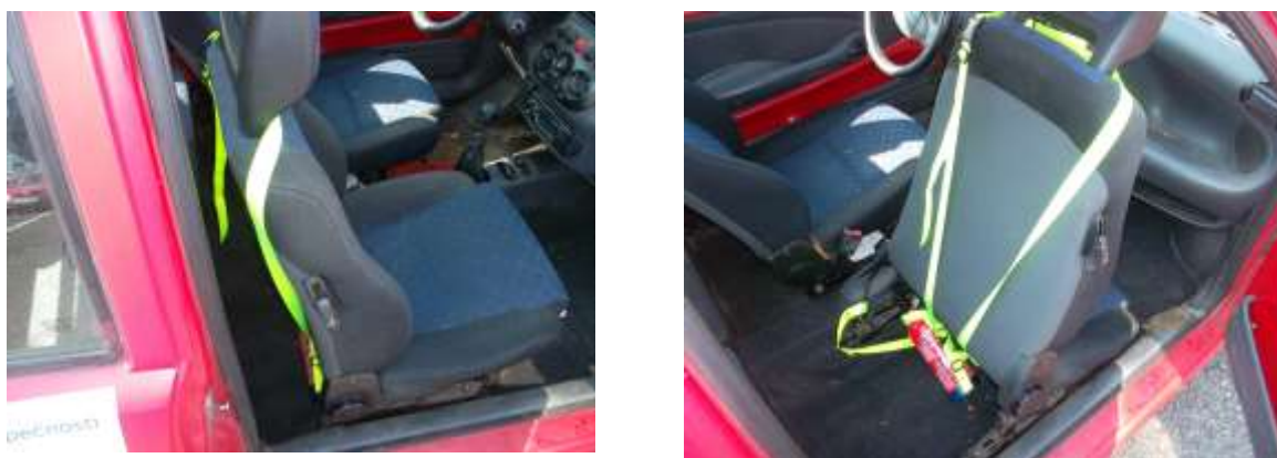
Obr. č. 33 - Upevnění hasicího přístroje ve vozidle Fiat Seicento před crash testem
