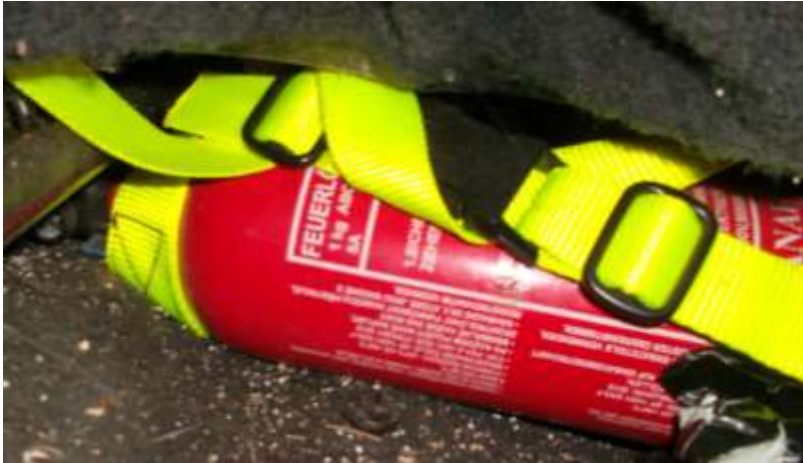
Obr. č. 40 - Detail hasicího přístroje ve vozidle Ford Escort po crash testu
