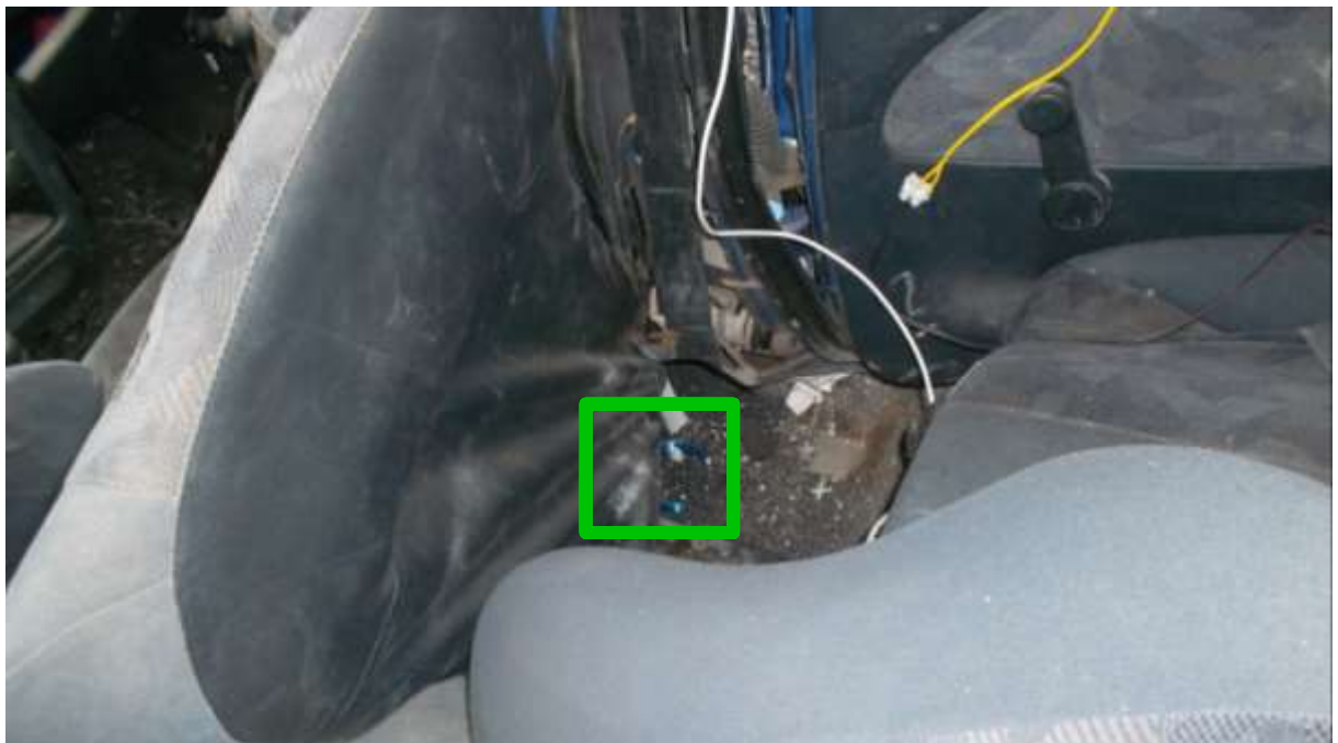
Obr. č. 39 - Interiér vozidla Ford Escort po crash testu; v zeleném čtverci je patrný fragment 3D tištěné podložky hasicího přístroje
