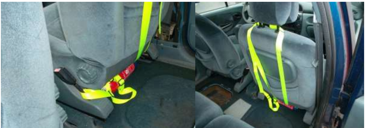
Obr. č. 42 - Upevnění hasicího přístroje ve vozidle Renault Scénic před crash testem
