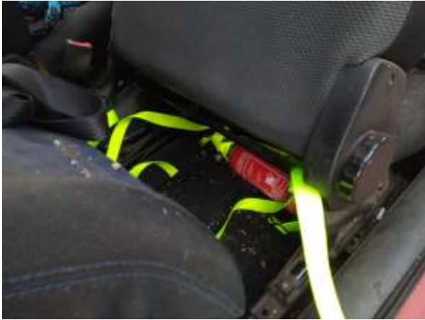
Obr. č. 35 - Hasicí přístroj ve vozidle Fiat Seicento po crash testu (popruhy byly rozepnuty až těsně před pořízení fotografie)
