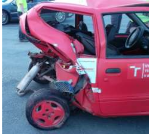
Obr. č. 36 - Detailní pohled na poškození zadní části vozidla Fiat Seicento; navzdory rozsáhlé deformaci bylo možné otevřít dveře spolujezdce, sklopit sedadlo a vyjmout hasicí přístroj
