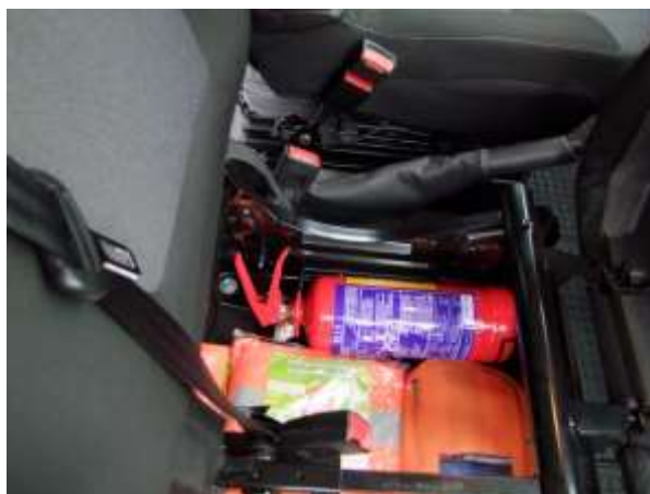
Obr. č. 7 - Hasicí přístroj v úložném prostoru pod sedadlem spolujezdce
