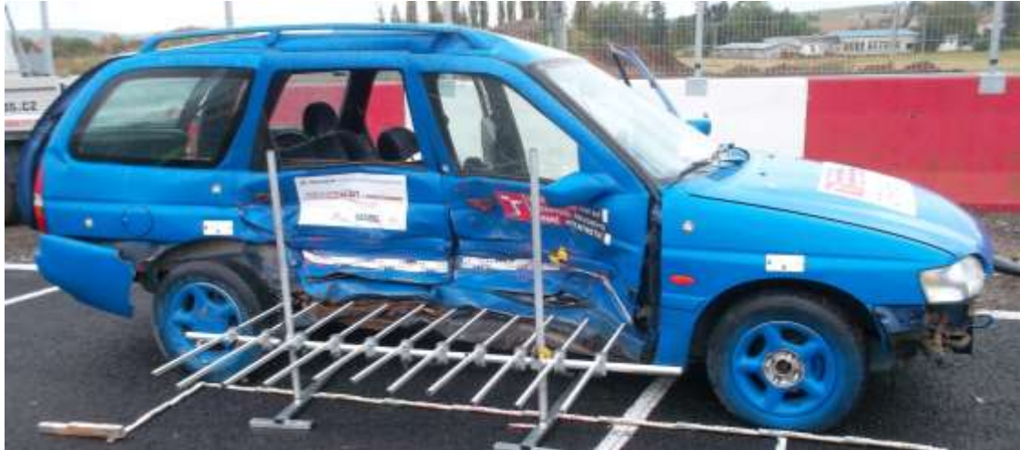
Obr. č. 38 - Deformace (během jejího odměřování) vozidla Ford Escort po crash testu
