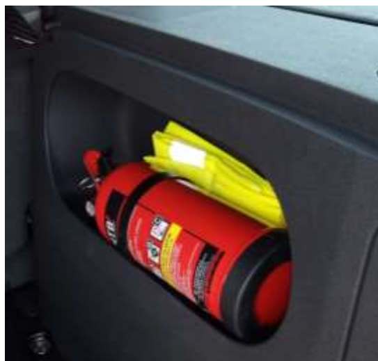
Obr. č. 5 - Příklad využití originálního držáku k uložení 2kg hasicího přístroje v zavazadlovém prostoru VW Caddy [foto: autor]
