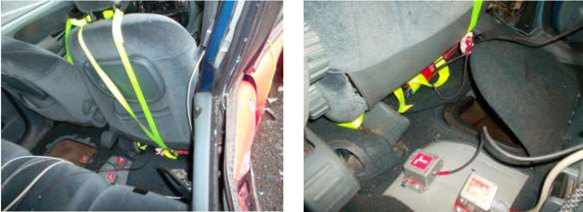
Obr. č. 43 - Upevnění hasičího přístroje ve vozidle Renault Scenic po crash testu
