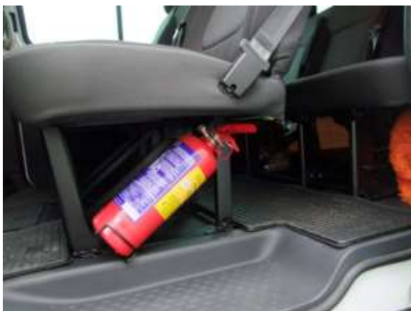
Obr. č. 6 - 2kg hasicí přístroj upevněný na rámu prostřední řady sedadel
