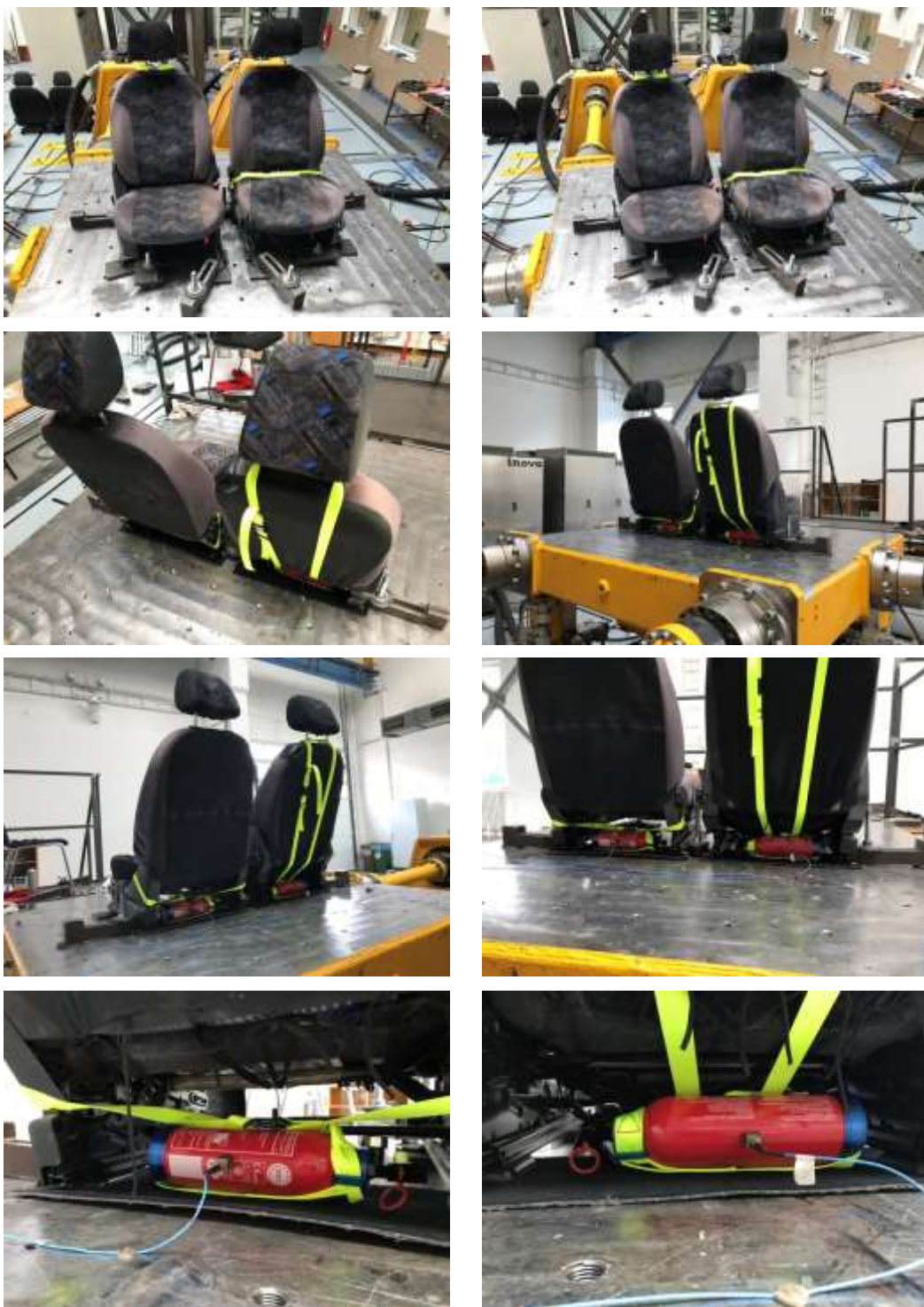
Obr. č. 25 – Upevnění sedadel a hasičích přístrojů k testovacímu zařízení
