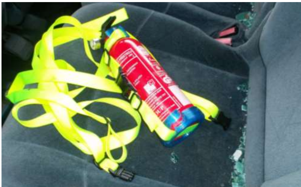
Obr. č. 44 - Poškození 3D tištěné části držáku
