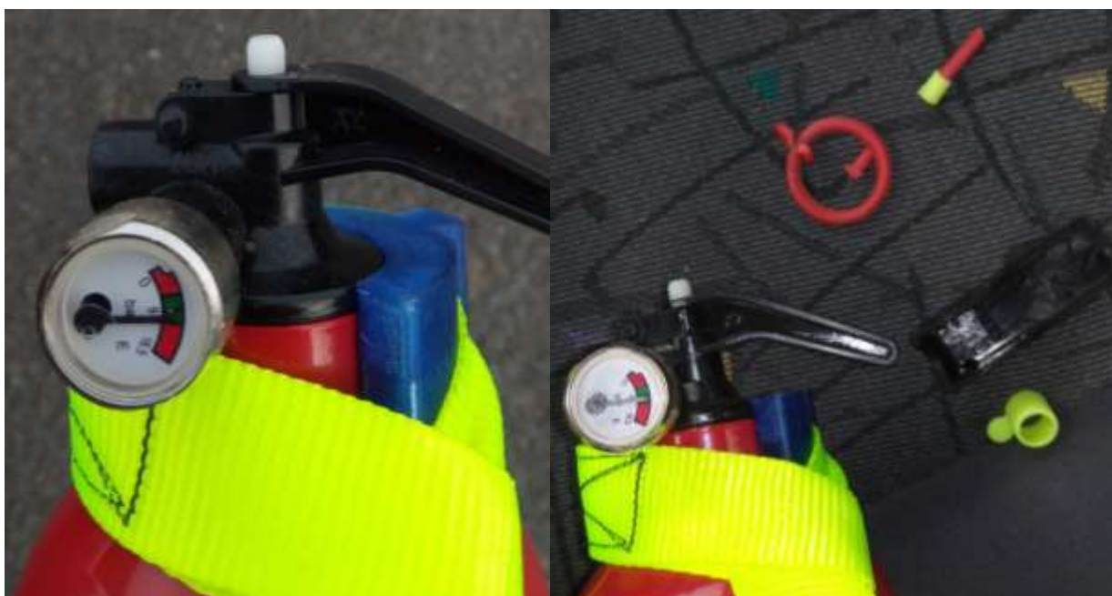
Obr. č. 31 - Detail na manometr hasicího přístroje po crash testu - je patrné, že je hnací plyn je v tlakové nádobě přítomen Obr. č. 32 - Ventil hasicího přístroje a součásti, které byly během crash testu odděleny
