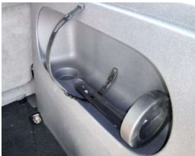
Obr. č. 4 - Příklad využití originálního držáku k uložení 2kg hasicího přístroje v zavazadlovém prostoru VW Caddy [foto: autor]
