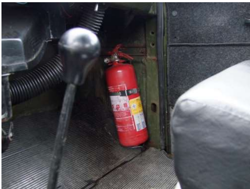
Obr. č. 9 - 2kg hasicí přístroj před dveřmi spolujezdce
