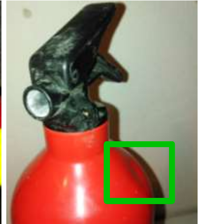
Obr. č. 41 - Detail na poškození hasicího přístroje; v zeleném obrazci je patrné promáčknutí tlakové nádoby
