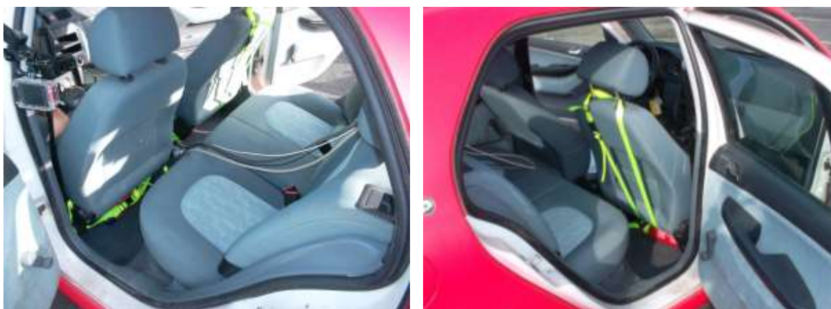
Obr. č. 27 - Upevnění hasicích přístrojů ve vozidle Škoda Fabia před crash testem
