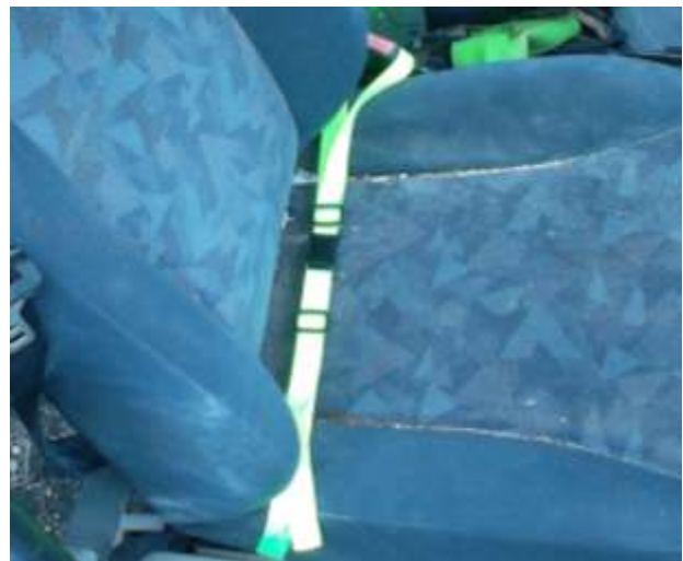
Obr. č. 37 - Upevnění hasicího přístroje ve vozidle Ford Escort před crash testem
