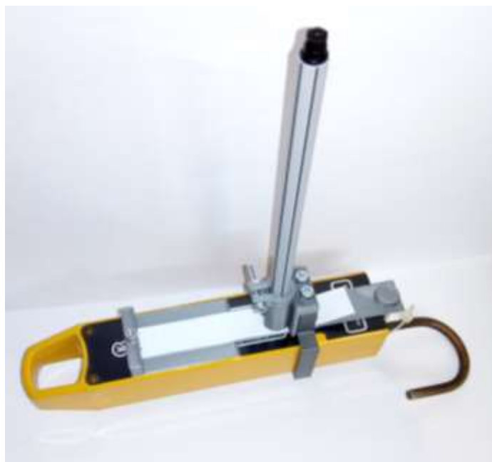
Obr. č. 17 - Měřicí zařízení pro orientační tahové zkoušky [foto: autor]
