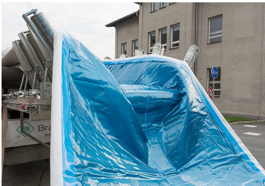
Obrázek 5.3 Ukázka sanační vložky KAWO UV opatřené ochranou fólií [14]
