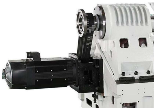
Obr. 19 Pohon vretena pomocou remeňového prevodu [20]
