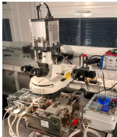
Obr. 4-3 Schéma experimentální aparatury a fotka aparatury tribometru BEAST [58]
