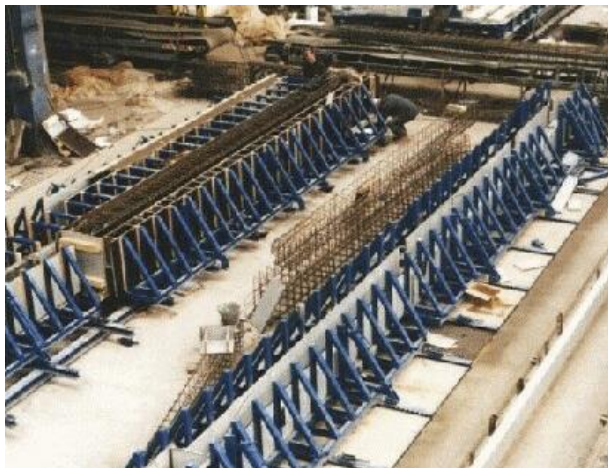
Obrázek 7 - Forma na výrobu tyčového prvku [17]
