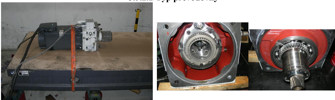
Obr. 37. – a) Ilustrativní uspořádání motoru; b), c) planetová dvoustupňová převodovka Baruffaldi – CE13, i=4,923 ; 60W.
