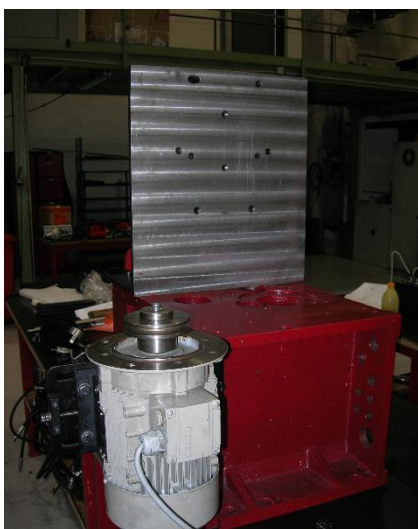
Obr. 7. – a) Ilustrativní fotografie 1. měřeného vzorku; b) ilustrace uspořádání: konzola užívaná pro záběhy malých obráběcích hlav. Motor byl upevněn pomocí patek. Korelace mezi upevněním pomocí příruby nebo patek, vibrační a spektrem proudu se nijak průkazně nelišily.
