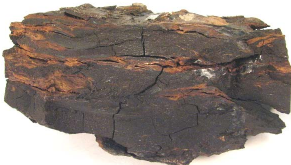
Obr. 1 Lignit – hemifázní semidetritický typ. Vzorek z jihomoravského revíru, důl 9. květen 19 .
