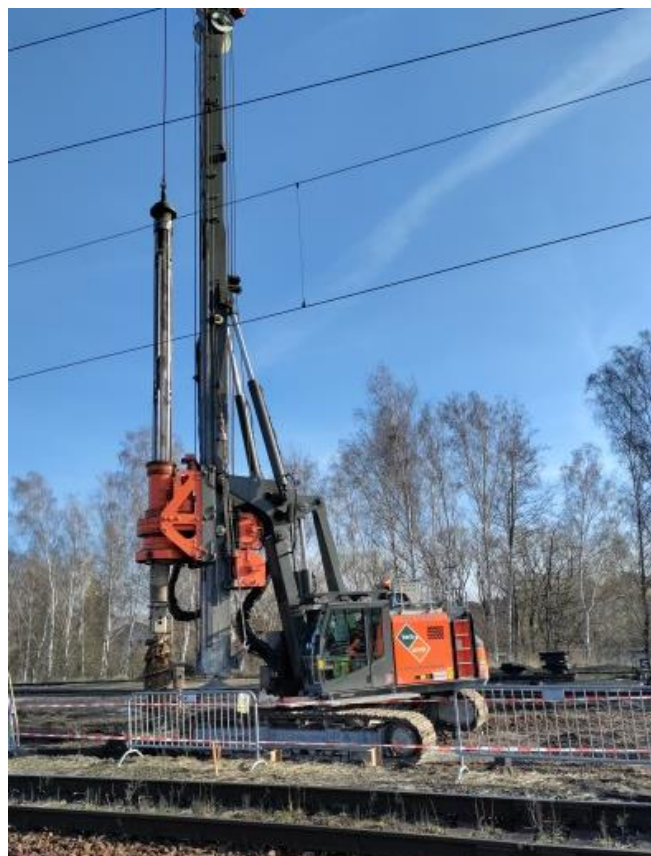
Obrázek 48 : Vrtná souprava DELMAG RH18, foto autor [48]
