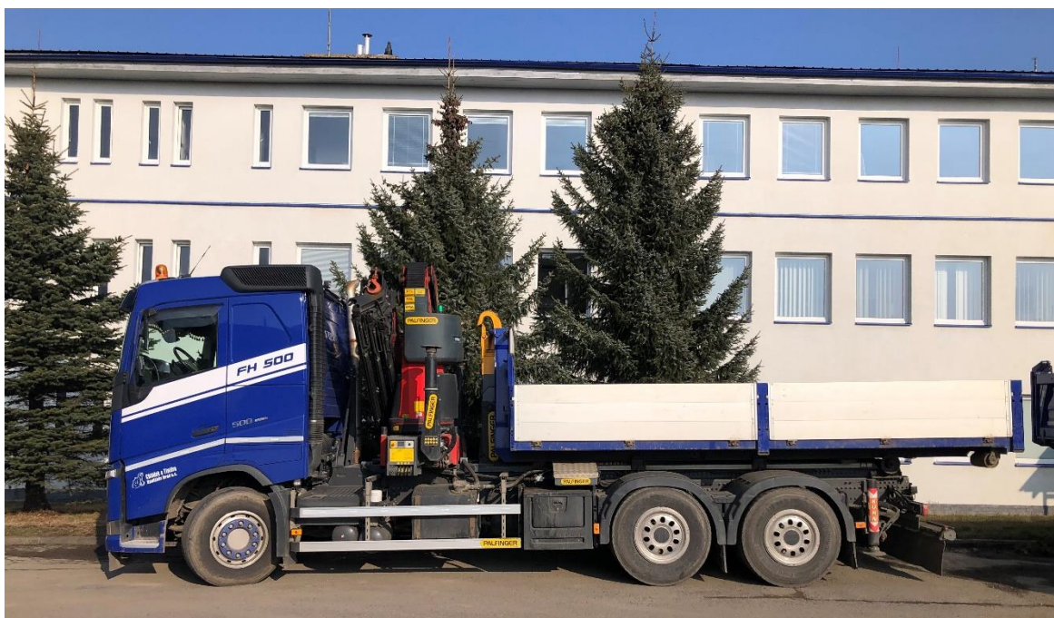
Obrázek 51: Nákladní automobil Volvo FH 500 s hydraulickou rukou , foto autor [51]
