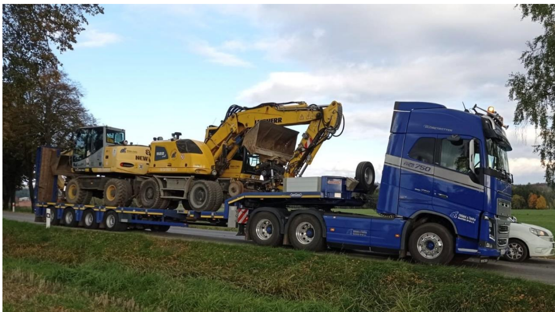
Obrázek 49 : Souprava Volvo FH 750 a podvalník Nootboom OSDS-58-04V, foto autor [49]
