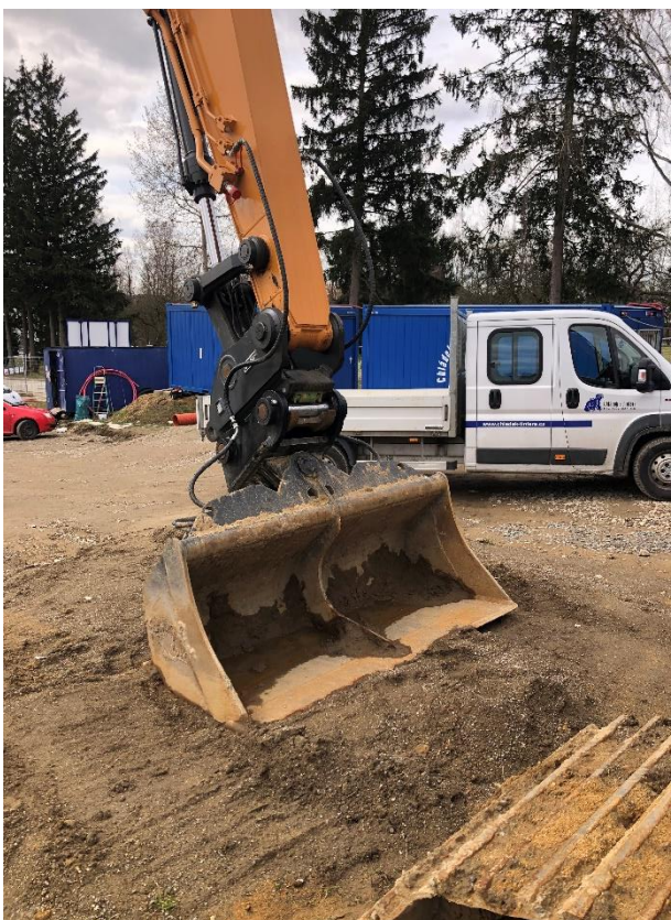
Obrázek 34 : Pásové rypadlo CASE CX300E- svahová lžíce foto autor [34]
