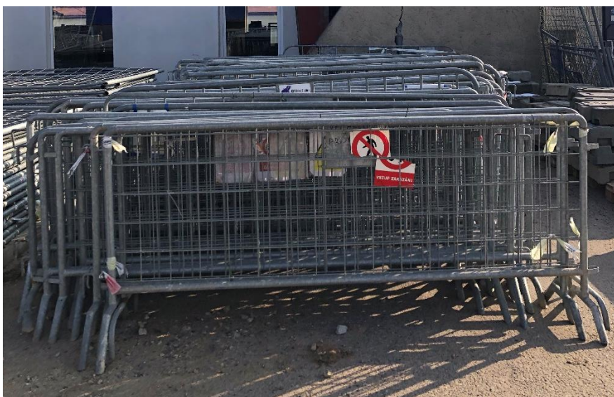
Obrázek 27 : Mobilní oplocení výšky 1,1 m , foto autor [27]
