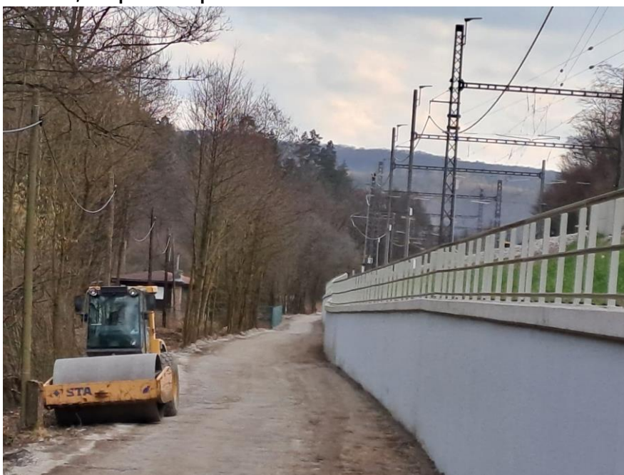
Obrázek 68 : Válec VV 1500 D, foto autor [68]
