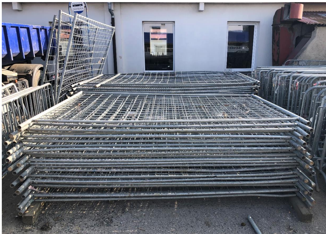
Obrázek 28 : Mobilní oplocení výšky 2 m , foto autor [28]
