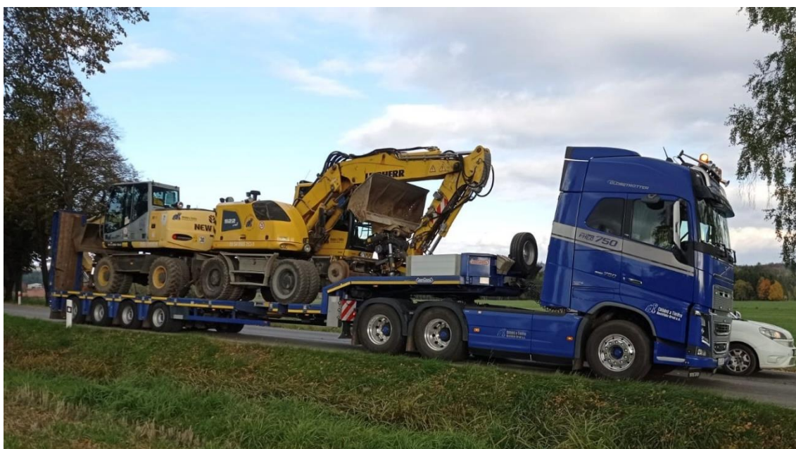
Obrázek 50 : Souprava Volvo FH 750 a podvalník Nootboom OSDS-58-04V, foto autor [50]
