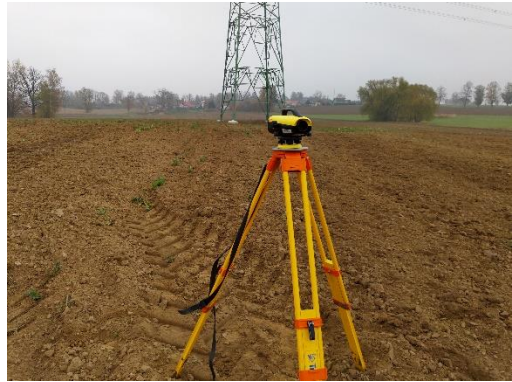
Obrázek 72 : Nivelační přístroj Leica Sprinter 150, foto autor [72]
