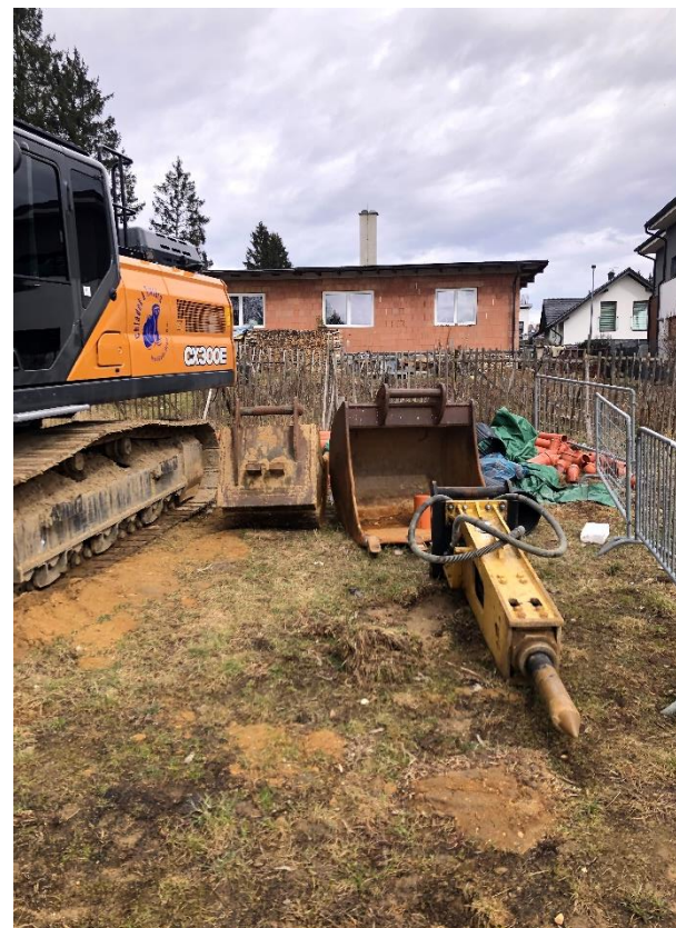
Obrázek 35 : rypadlo CASE CX300E- zubatá lžíce 160, foto autor [35]
