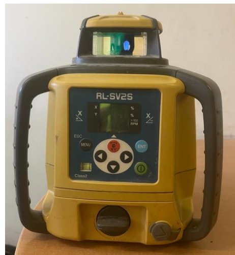
Obrázek 73 : Rotační laser Topcon RL-SV2S, foto autor [73]
