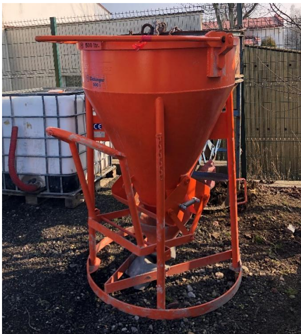
Obrázek 63 : Bádíe Eichinger 500l, foto autor [63]
